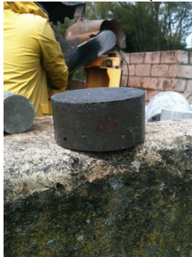
Fotografía 63. Muestra cortada del espesor necesario para ensayo de permeabilidad al ion cloruro
