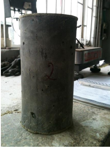
Fotografía 45. Probeta 0% de porcentaje de reemplazo fallada a 28 días a compresión
