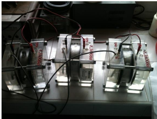
Fotografía 74. Muestras durante ensayo de permeabilidad al ion cloruro
