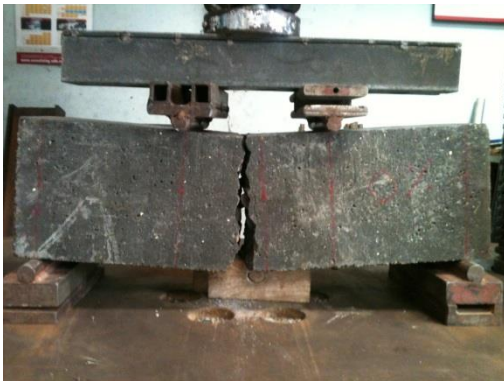
Fotografía 56. Vigueta de 0% de reemplazo fallada a flexión indirecta a 28 días de fundida
