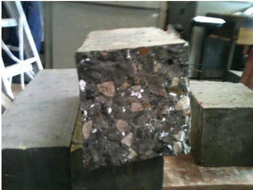
Fotografía 52. Vigueta de 20% (primera muestra) de reemplazo fallada a flexión indirecta a 28 días de fundida
