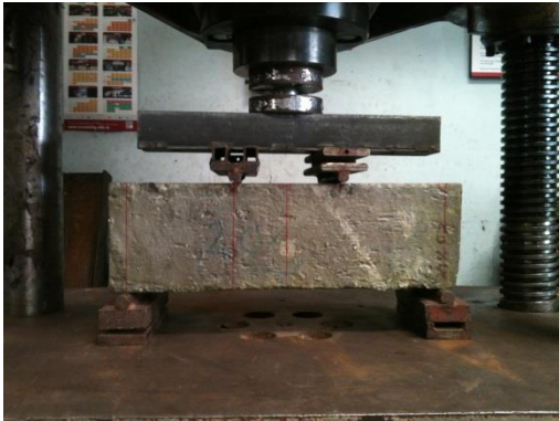
Fotografía 50. Vigueta de 20% de reemplazo ensayada a flexión indirecta a 28 días de fundida
