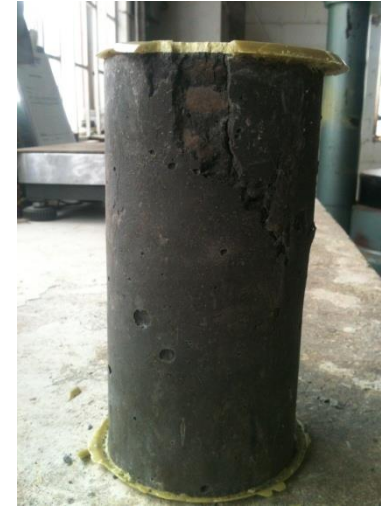
Fotografía 38. Probeta mezcla 0% de reemplazo ensayada a compresión a los 14 días de curado
