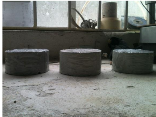
Fotografía 67. Muestras con capa de epóxico para ensayo de permeabilidad al ion cloruro
