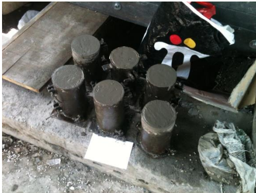
Fotografía 1. Elaboración probetas con mezcla de prueba
