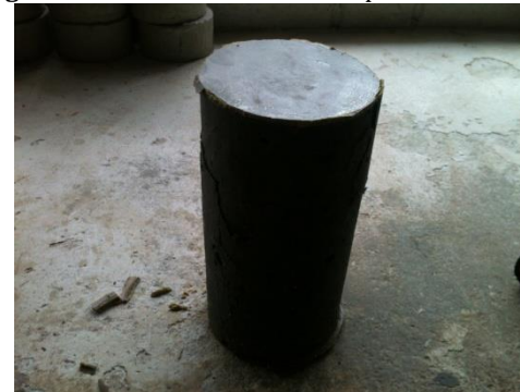
Fotografía 30. Probeta fallada a compresión axial a 7 días
