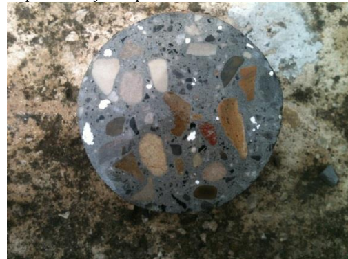
Fotografía 63. Muestra cortada del espesor necesario para ensayo de permeabilidad al ion cloruro
