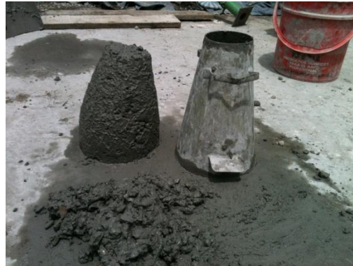
Fotografía 24. Toma del asentamiento de cada mezcla. Este valor varió entre 7 y 9 cm.
