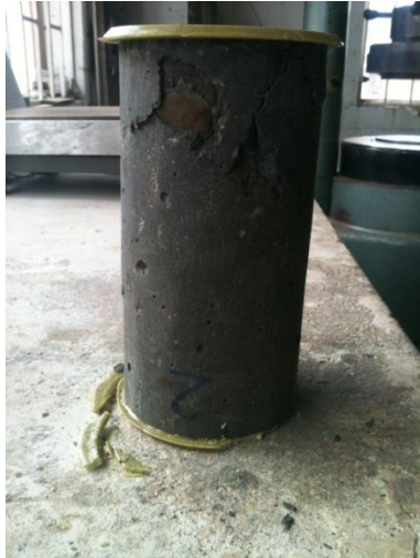
Fotografía 39. Probeta mezcla 0% de reemplazo ensayada a compresión a los 14 días de curado
