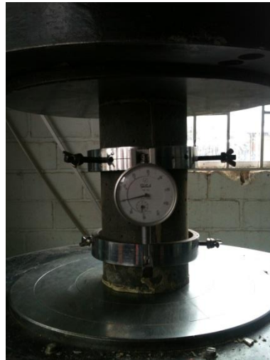
Fotografía 47. Probeta ensayada a compresión y toma de deformaciones a 28 días de fundida
