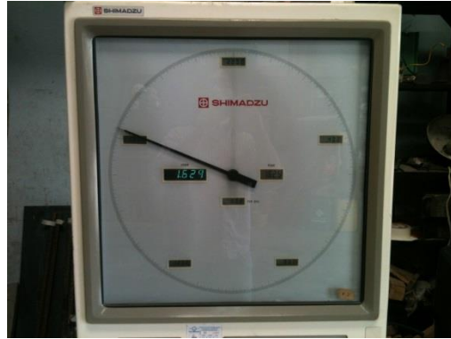
Fotografía 49. Medidor de la carga aplicada, equipo de ensayo a flexión indirecta
