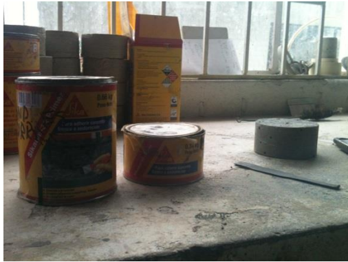
Fotografía 66. Epóxico utilizado para sellar las muestras previo al ensayo de permeabilidad al ion cloruro
