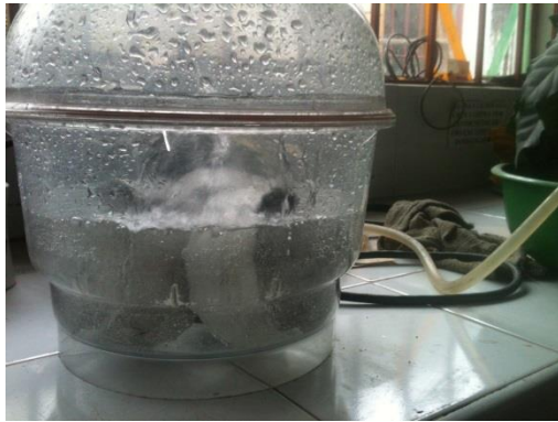
Fotografía 72. Muestras en equipo de vacío con agua destilada
