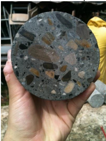
Fotografía 64. Detalle muestra cortada para ensayo de permeabilidad al ion cloruro
