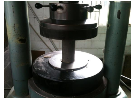
Fotografía 26. Ensayo a compresión probetas a 7 días
