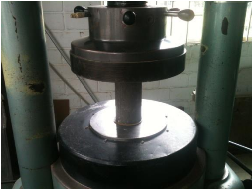
Fotografía 4. Ensayo de compresión simple probetas con mezcla de prueba a los 3 días de vaciado
