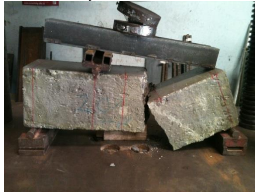
Fotografía 51. Vigueta de 20% (primera muestra) de reemplazo fallada a flexión indirecta a 28 días de fundida
