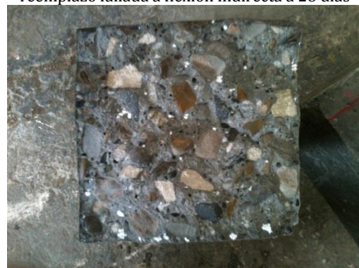
Nota: se observa el icopor de desecho mezclado Fotografía 59. Detalle vigueta de 10% de reemplazo fallada a flexión indirecta a 28
