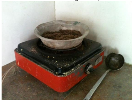
Fotografía 15. Determinación del contenido de humedad de los agregados
