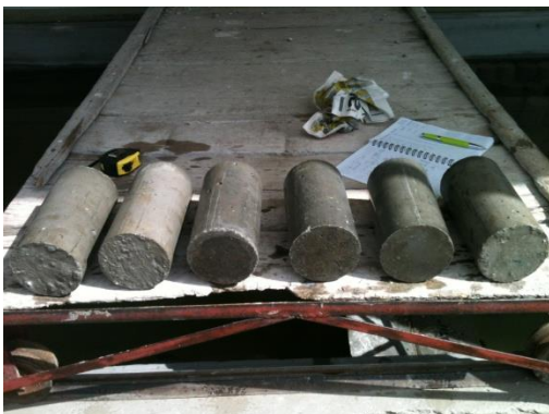
Fotografía 31. Probetas para ensayar a compresión a los 14 días de curado
