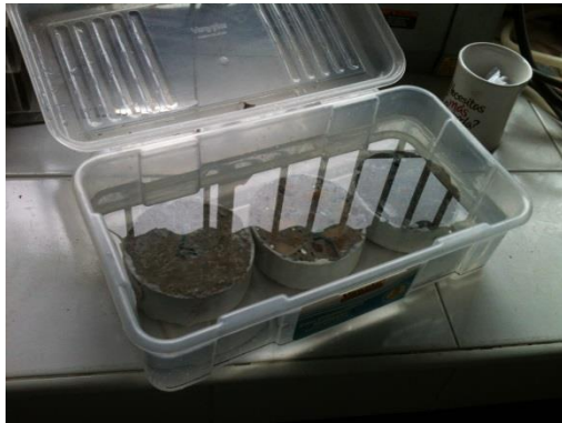
Fotografía 68. Muestras sumergidas en agua destilada previo al ensayo de permeabilidad al ion cloruro
