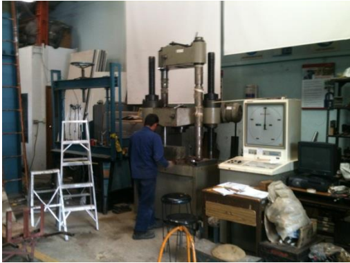
Fotografía 48. Equipo para ensayo de viguetas a flexión indirecta
