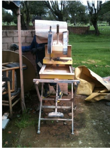
Fotografía 61. Equipo para cortar las probetas en muestras de 5,0 cm de espesor
