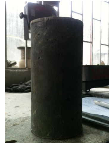
Fotografía 44. Probeta 20% de porcentaje de reemplazo fallada a 28 días a compresión
