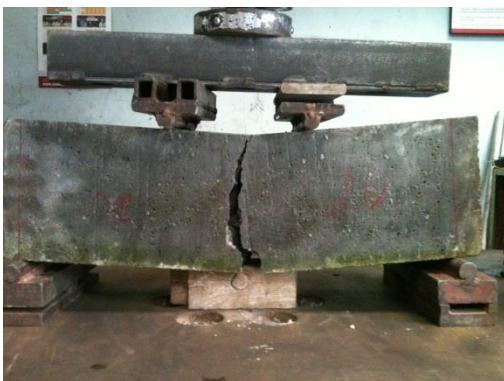
Fotografía 58. Vigueta de 20% (segunda muestra) de reemplazo fallada a flexión indirecta a 28 días de fundida
