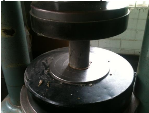
Fotografía 29. Momento de falla a compresión probeta a 7 días
