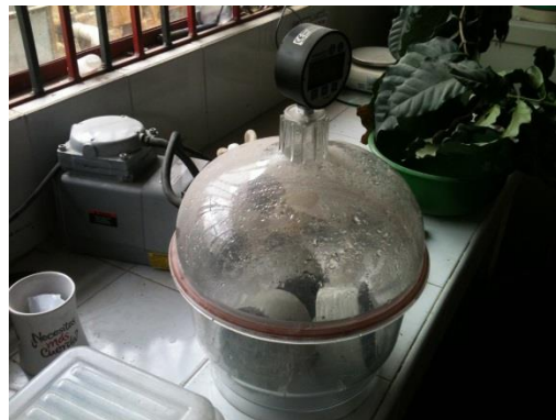
Fotografía 71. Muestras en equipo de vacío
