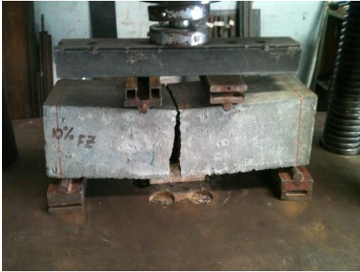
Fotografía 54. Vigueta de 10% de reemplazo fallada a flexión indirecta a 28 días de fundida
