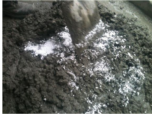
Fotografía 19. Mezcla de icopor molido con el resto de materiales
