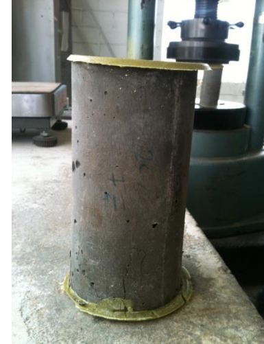
Fotografía 34. Probeta mezcla 20% de reemplazo ensayada a compresión a los 14 días de curado
