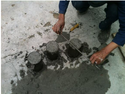
Fotografía 20. Elaboración de probetas
