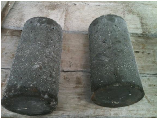
Fotografía 3. Probetas con mezcla de prueba a los 3 días de vaciado
