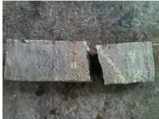
Fotografía 51. Vigueta de 20% (primera muestra) de reemplazo fallada a flexión indirecta a 28 días de fundida
