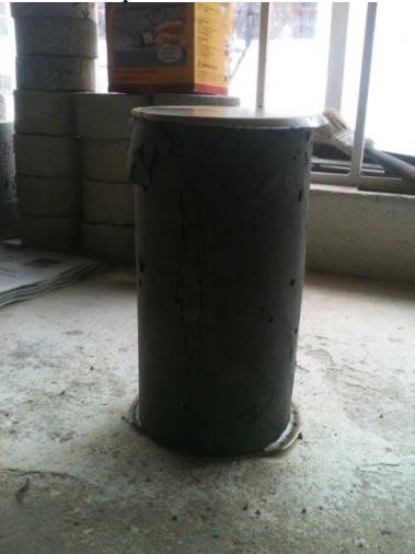
Fotografía 6. Probeta con mezcla de prueba fallada a compresión a los 3 días de vaciado
