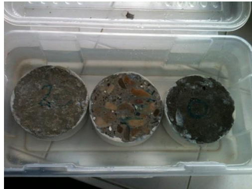
Fotografía 69. Muestras sumergidas en agua destilada previo al ensayo de permeabilidad al ion cloruro
