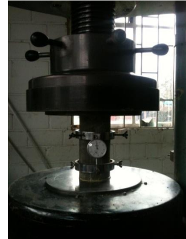
Fotografía 42. Probeta durante ensayo a compresión a 28 días. En este ensayo también se tomaron deformaciones para calcular el módulo de elasticidad
