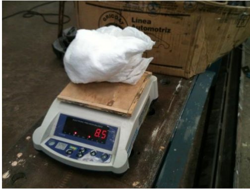
Fotografía 18. Toma de pesos para determinar cantidad de icopor a mezclar
