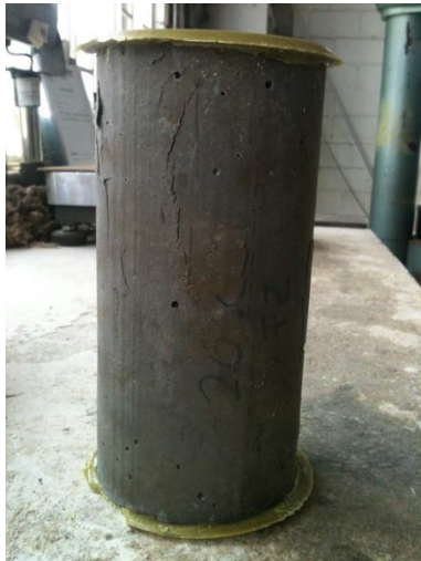
Fotografía 35. Probeta mezcla 20% de reemplazo ensayada a compresión a los
