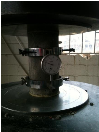
Fotografía 46. Probeta ensayada a compresión y toma de deformaciones a 28 días de fundida
