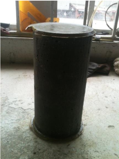
Fotografía 5. Probeta con mezcla de prueba fallada a compresión a los 3 días de vaciado
