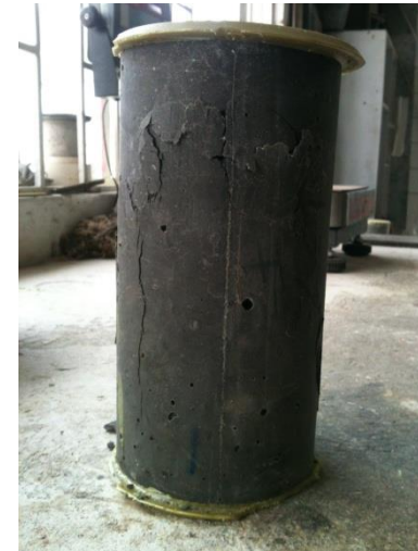
Fotografía 36. Probeta mezcla 10% de reemplazo ensayada a compresión a los
