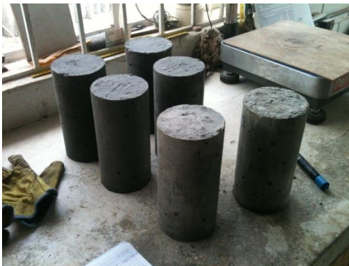
Fotografía 25. Probetas para ensayo a compresión a 7 días
