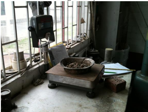
Fotografía 14. Determinación del contenido de humedad de los agregados
