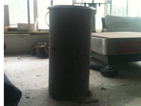
Fotografía 28. Probeta fallada a compresión axial a 7 días
