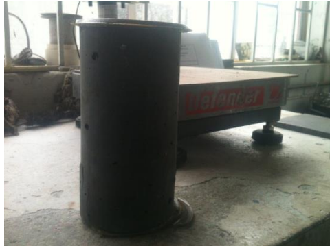
Fotografía 27. Probeta fallada a compresión axial a 7 días
