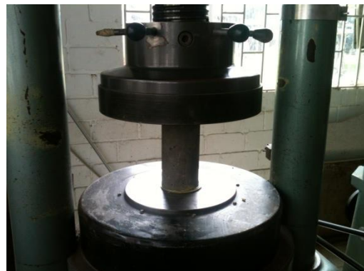
Fotografía 32. Ensayo a compresión de probetas a los 14 días de curado
