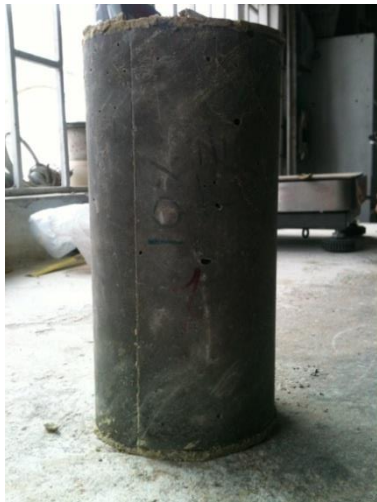
Fotografía 43. Probeta 10% de porcentaje de reemplazo fallada a 28 días a compresión
