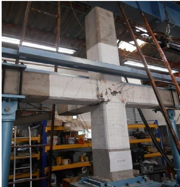
Figura 6-8. Espécimen NSR-10 en su condición final de falla. Fuente: El autor
