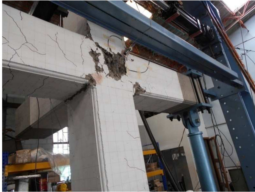
Figura 6-7. Espécimen PRE-1984 en su condición final de falla. Fuente: El autor
