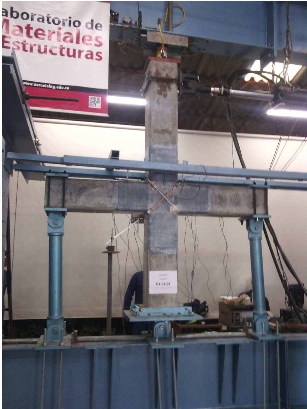
Figura 6-9. Espécimen REF.CFRP en su condición final de falla. Fuente: El autor
