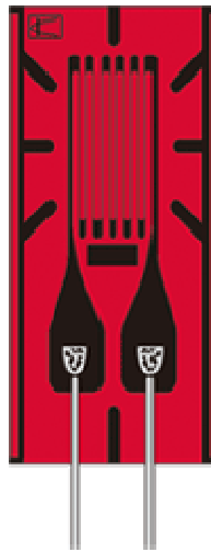
Figura 4-8. Galga. Fuente: Recuperado de http://www.kyowa-ei.com
