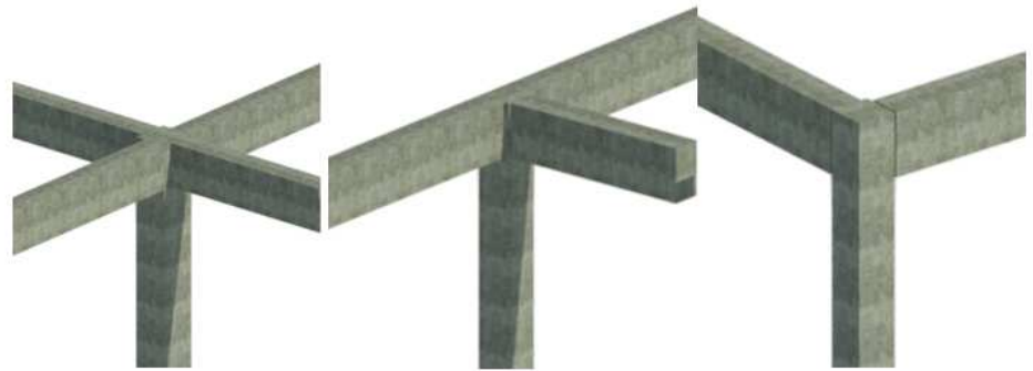
a. Interior Cubierta b. Exterior Cubierta c. Esquina Cubierta
