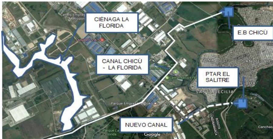
Figura 18. Esquema en planta del posible bombeo del efluente de la PTAR El Salitre. Fuente: Google Maps.
