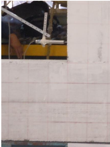
Fotografía 2- 20: Localización de LVDTs MG5040
