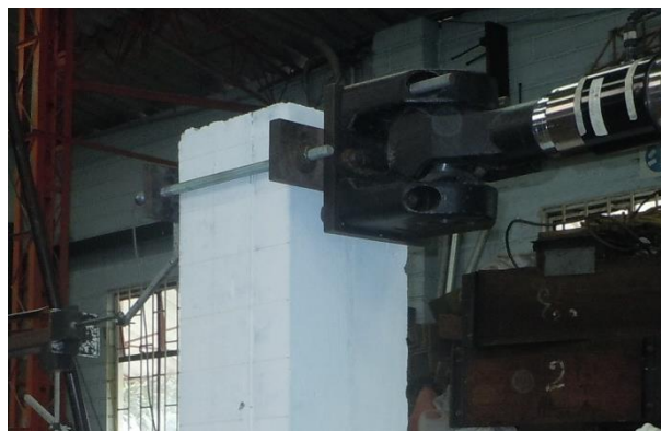
Fotografía 2- 18: Fijación del espécimen al gato hidráulico
