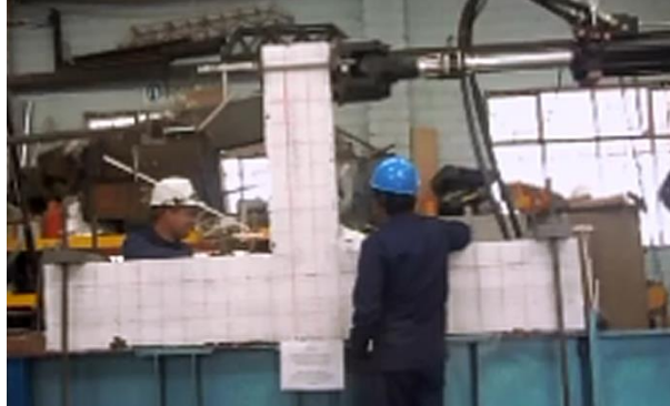
Fotografía 3- 19: Condición inicial prototipo AENC-10
