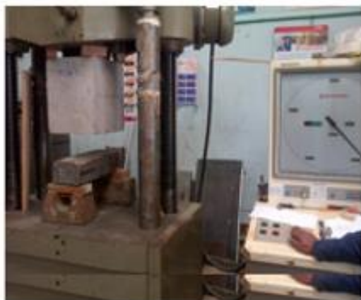
(c) Ensayo de extracción para anclaje con adhesivo 3
