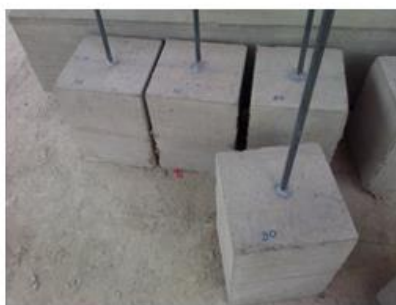
(c) Barras ancladas en macizos con adhesivo 3
