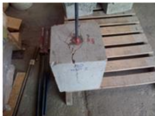
(b) Ensayo de extracción para anclaje con adhesivo 2
