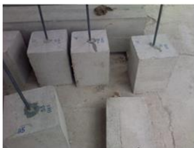
(a) Barras ancladas en Macizos con adhesivo 1
