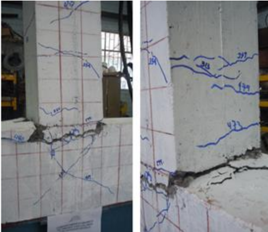
Fotografía 3- 14: Condición del prototipo AENC-7, después del ensayo
