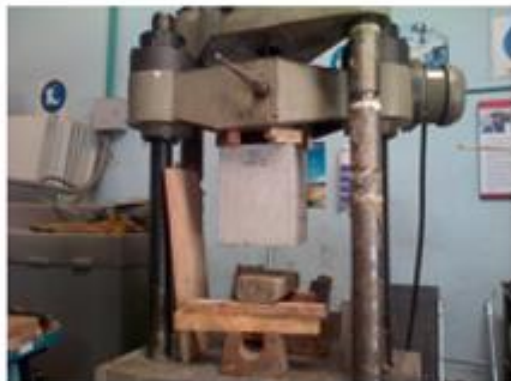
(b) Ensayo de extracción para anclaje con adhesivo 2
