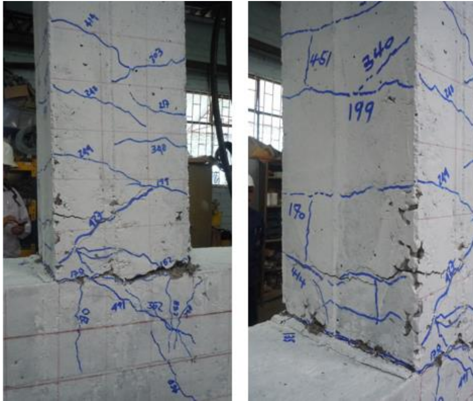
Fotografía 3- 18: Condición del prototipo AENC-9, después del ensayo
