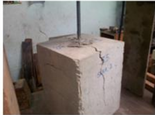
(a) Ensayo de extracción para anclaje con adhesivo 1
