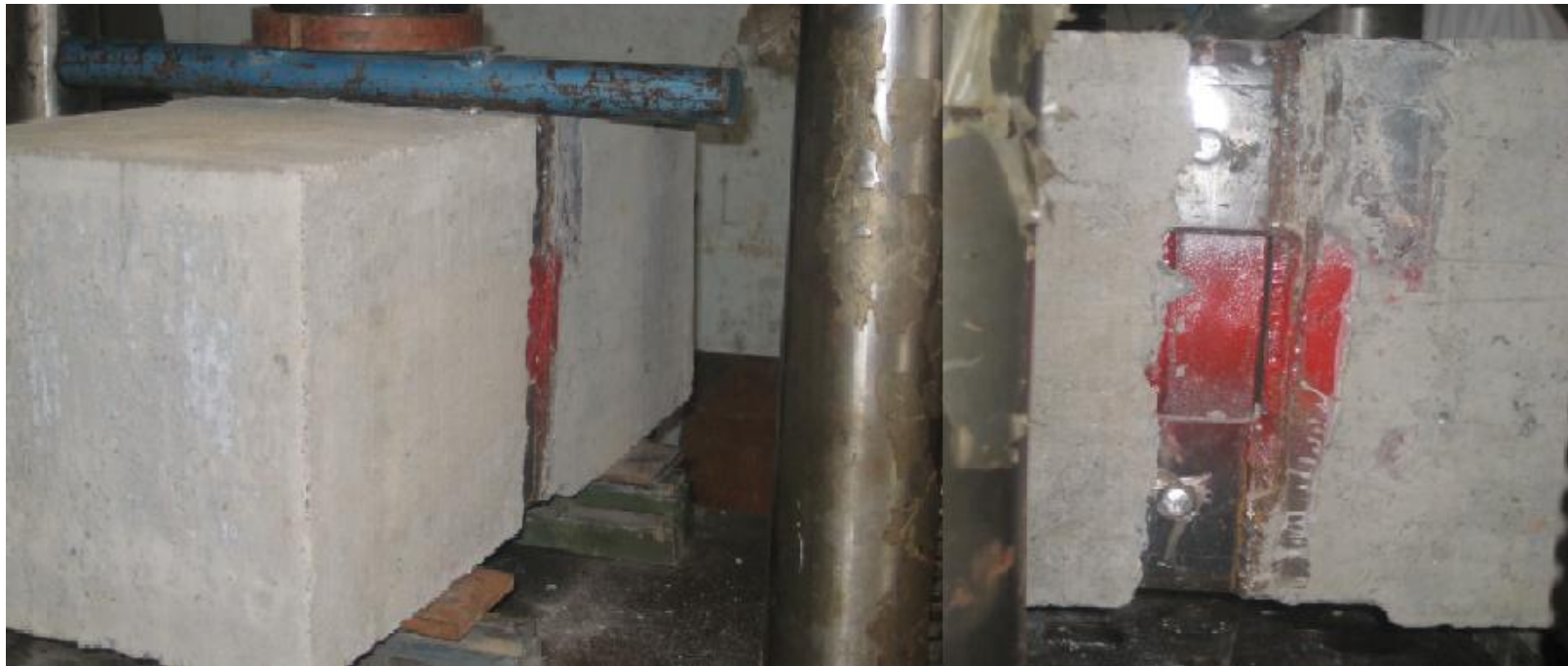
Imagen 3-9. Modelo real No 1 corte.
