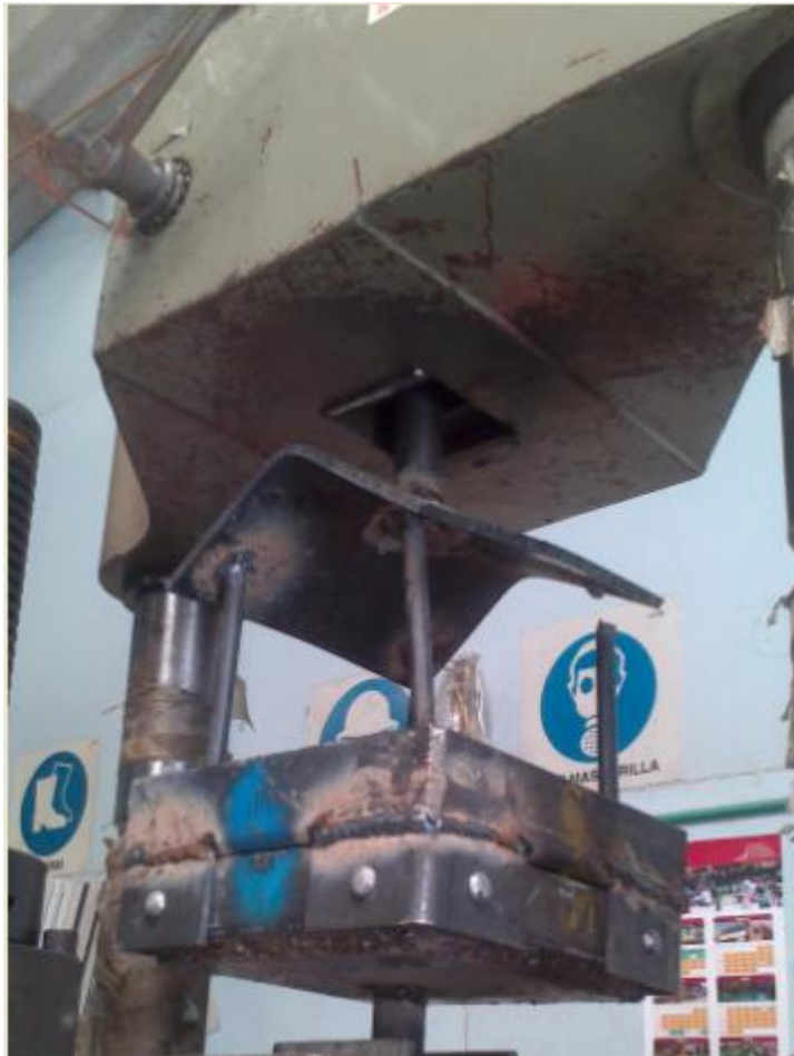
Imagen 3-2. Falla del modelo real No.1.
