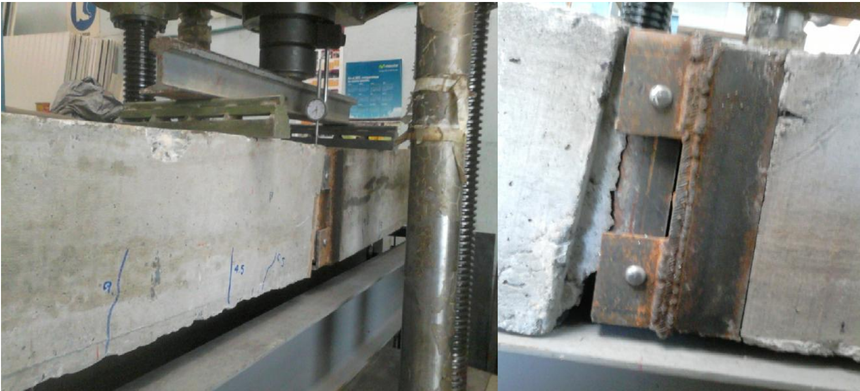
Imagen 3-13. Falla modelo real No 1 flexión.
