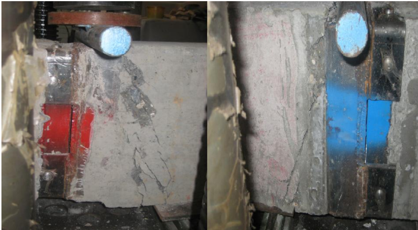
Imagen 3-10. Falla modelo real No 1 corte.
