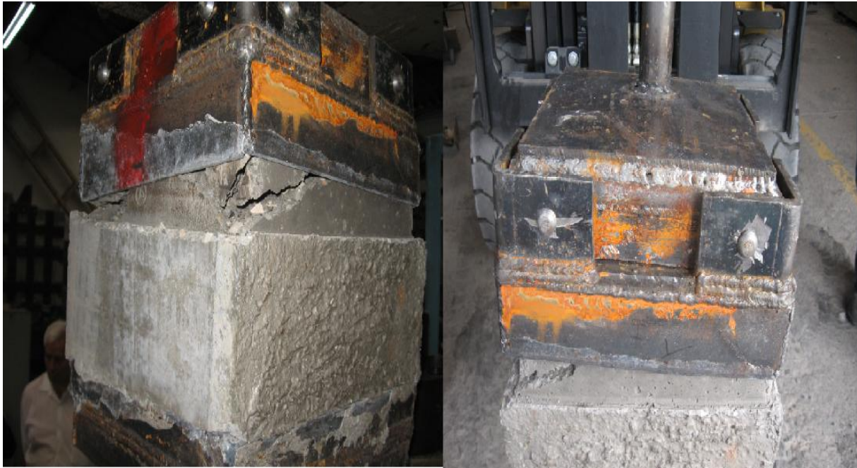
Imagen 3-8. Falla modelo real No 4.
