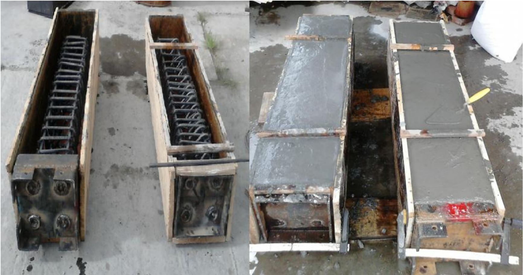
Imagen 3-11. Detalle de la fabricación de modelo 1 para el ensayo a flexión.
