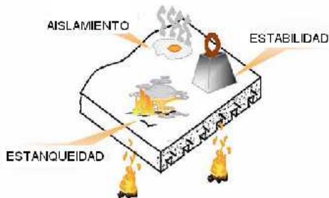
**Figura 5.1: Propiedades de resistencia al fuego de elementos de un compartimiento (Losas, paredes, puertas cortafuego)**
