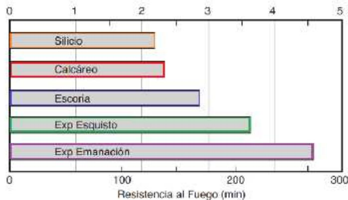
**Figura 4.4: Efectos de varios tipos de agregados sobre la resistencia al fuego de losas de 121 mm (4 ¾ pulg.)**
