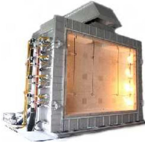
**Figura 9.17. Horno de prueba de resistencia al fuego**
