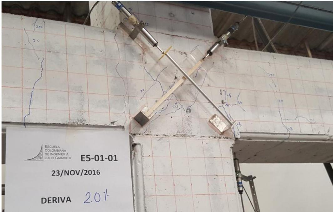
**Figura 5-2:** Estado del espécimen PRE-1984 a una deriva del 2.5%
