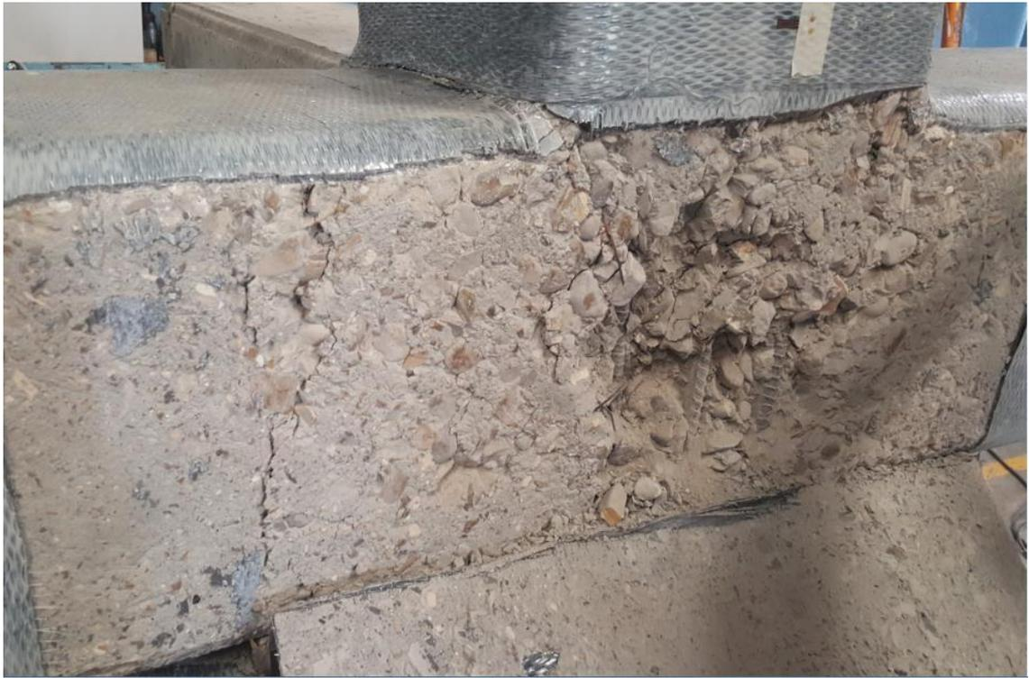
La ocurrencia de un mayor daño en la zona del nudo para este espécimen puede atribuirse a que, al ser reforzada la viga (manteniendo el mismo refuerzo a cortante), el nudo se vio sujeto a una mayor demanda de capacidad, la cual no fue capaz de soportar de manera adecuada. Es por ello que, en comparación con el espécimen FRP-1, la falla del espécimen se trasladó de la viga al nudo.
