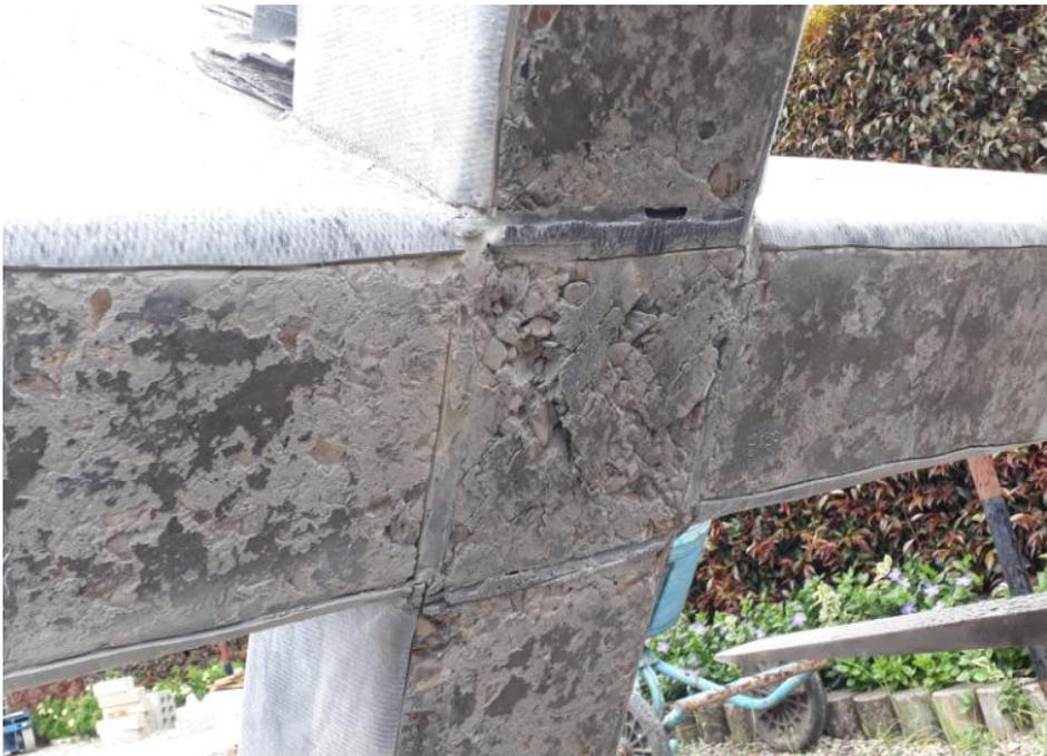
**Figura 5-10:** Estado final del espécimen E7-01-03 – Condición del nudo
