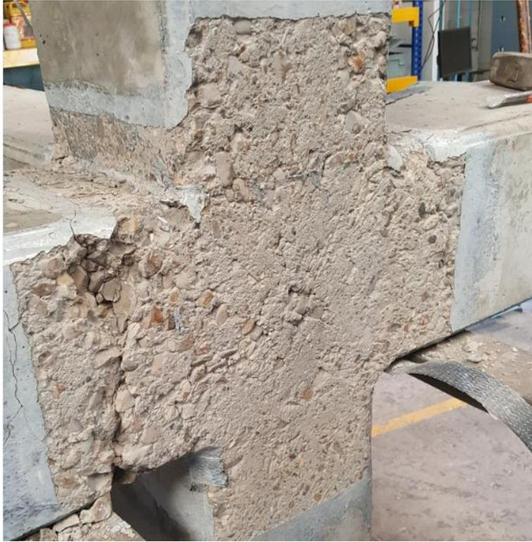
**Figura 5-6:** Falla localizada en ambos lados de la viga – Especímen E6-01-02
