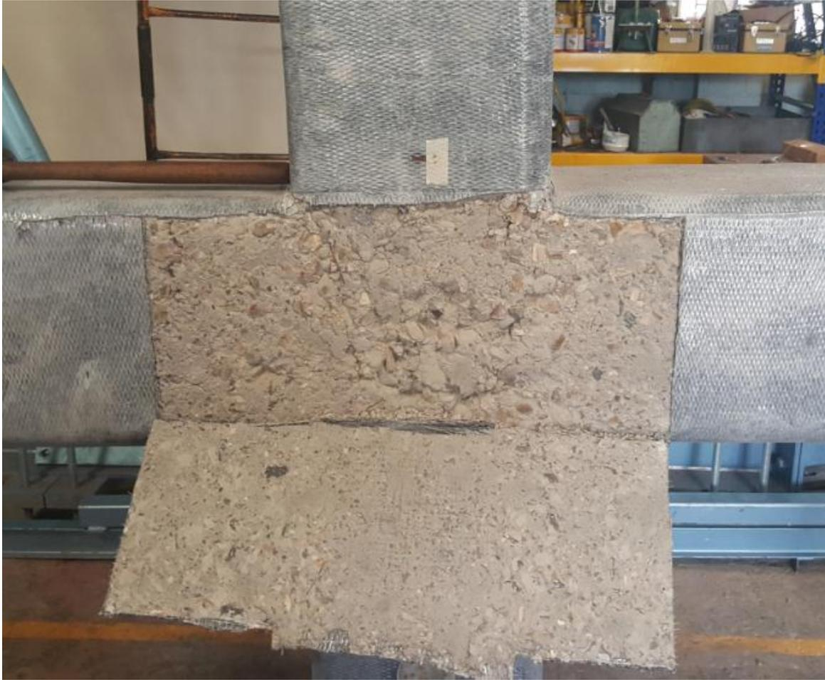
La degradación en la zona del nudo fue tal, que con tan solo tocar suavemente la superficie de dicha zona, el concreto se desprendió fácilmente (figura 5-8).
