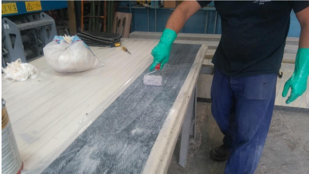
Fotografía 4.37 Preparación de las fibras de carbono
