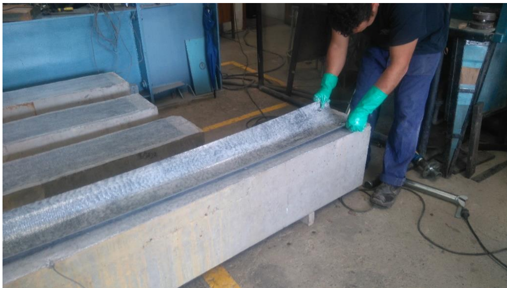
Fotografía 4.38 Instalación de las fibras de carbono en la viga V2
