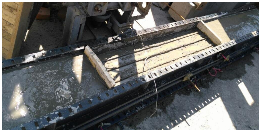
Fotografía 4.7 Simulación de la pérdida del recubrimiento del concreto
