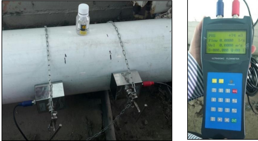
Ilustración 8. Instrumento de aforo de caudal. Fuente: Informe Modelación física de la bocatoma y del canal de aducción. ECI
