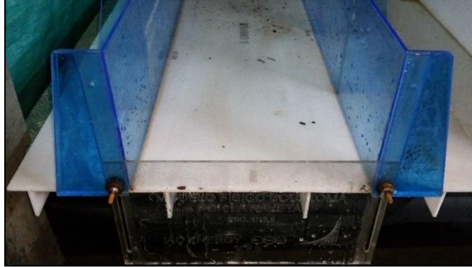
Ilustración 9. Rejilla como elemento de control del flujo en el modelo. Fuente: Informe Modelación física de la bocatoma y del canal de aducción. ECI
