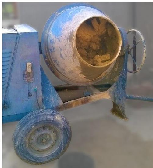
**Fotografía 4-28** Mezclado mecánico de mortero
