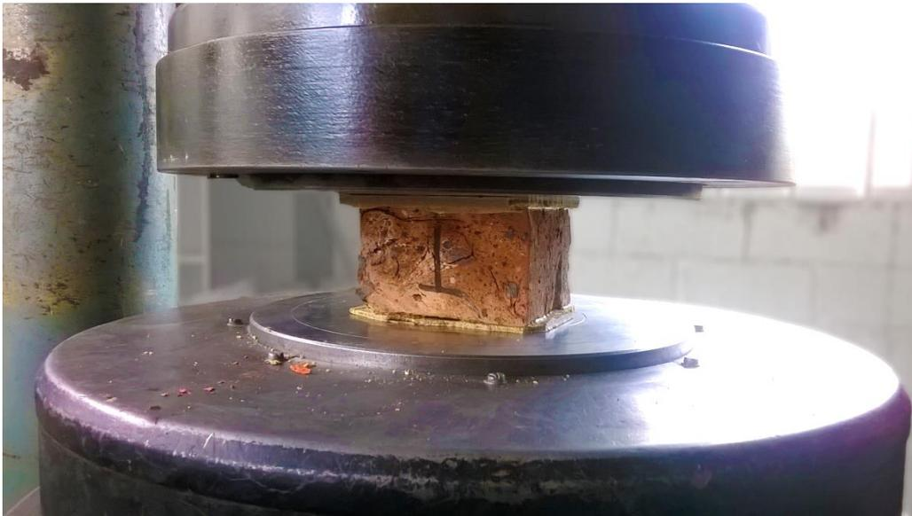
**Fotografía 5-1** Ensayo de resistencia a compresión en unidades de mampostería
