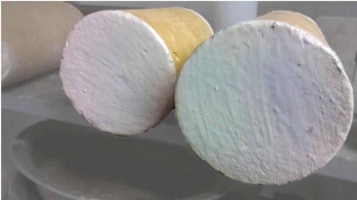
**Fotografía 4-16** Impermeabilización de caras de cilindros de mortero
