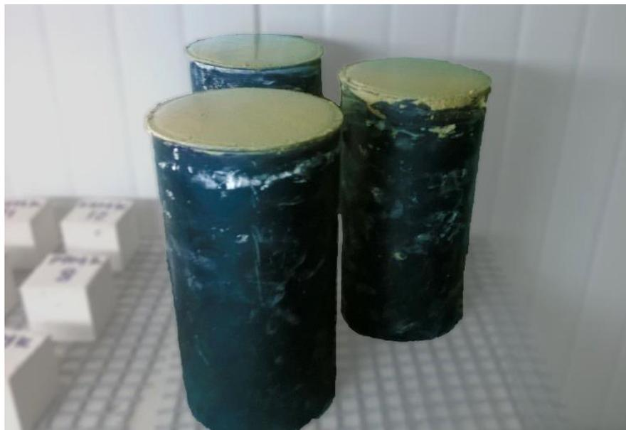
**Fotografía 4-15** Almacenamiento de moldes de cilindros en cámara de humedad y temperatura
