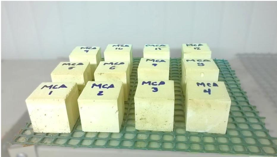
**Fotografía 4-10** Curado de cubos en cámara de humedad y temperatura
