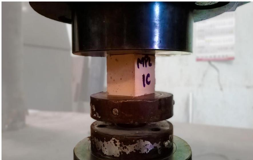
**Fotografía 5-3** Ensayo de resistencia a compresión en cubos de mortero
