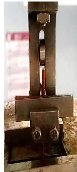
**Fotografía 5-7** Corte en la soldadura de la malla electrosoldada
