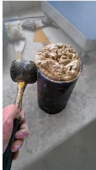
**Fotografía 4-14** Extracción de aire en el mortero
