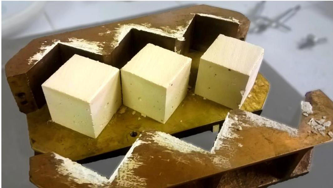
**Fotografía 4-9** Desmolde de cubos de mortero
