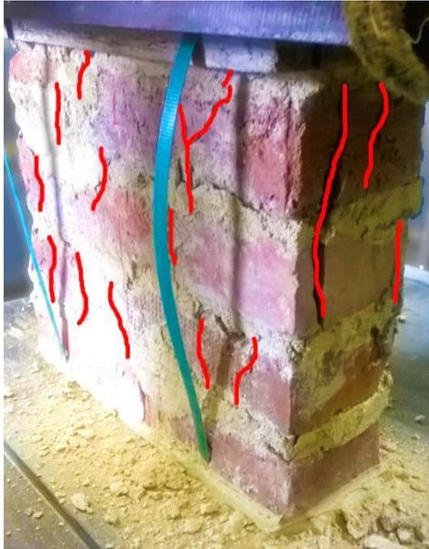
**Fotografía 5-16** Mecanismo de falla en murete de unidad y media, reforzado con barra de GFRP
