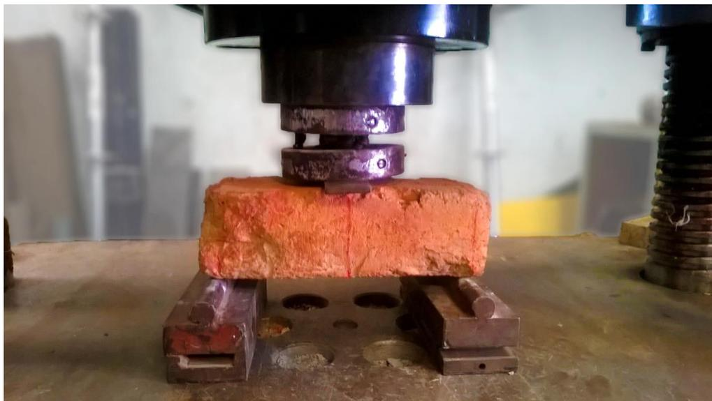
**Fotografía 5-2** Ensayo módulo de rotura en unidades de mampostería
