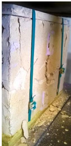
**Fotografía 5-13** Fisuración del revoque en murete de unidad y media, reforzado con malla electrosoldada
