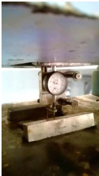
**Fotografía 5-6** Tensión en alambre de la malla electrosoldada
