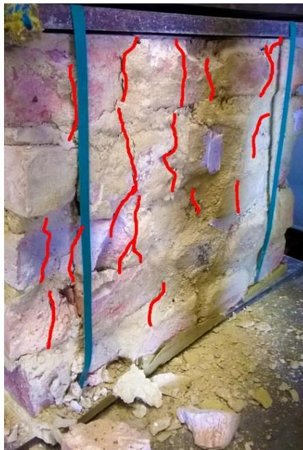
**Fotografía 5-23** Mecanismo de falla en murete mediano, reforzado con malla electrosoldada
