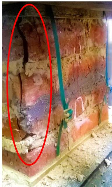
**Fotografía 5-17** Plano de falla en la cara reforzada con barra de GFRP en murete de unidad y media
