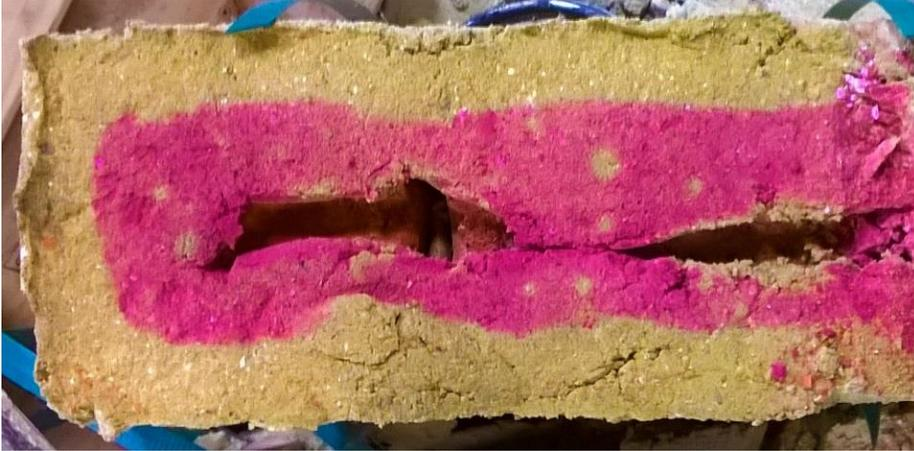
**Fotografía 5-11** Junta de murete de unidad y media, fabricado con mortero de cal, parcialmente carbonatada
