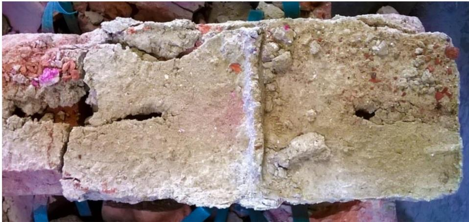
**Fotografía 5-19** Junta de mortero de cal adicionado con metacaolín, en murete de unidad y media
