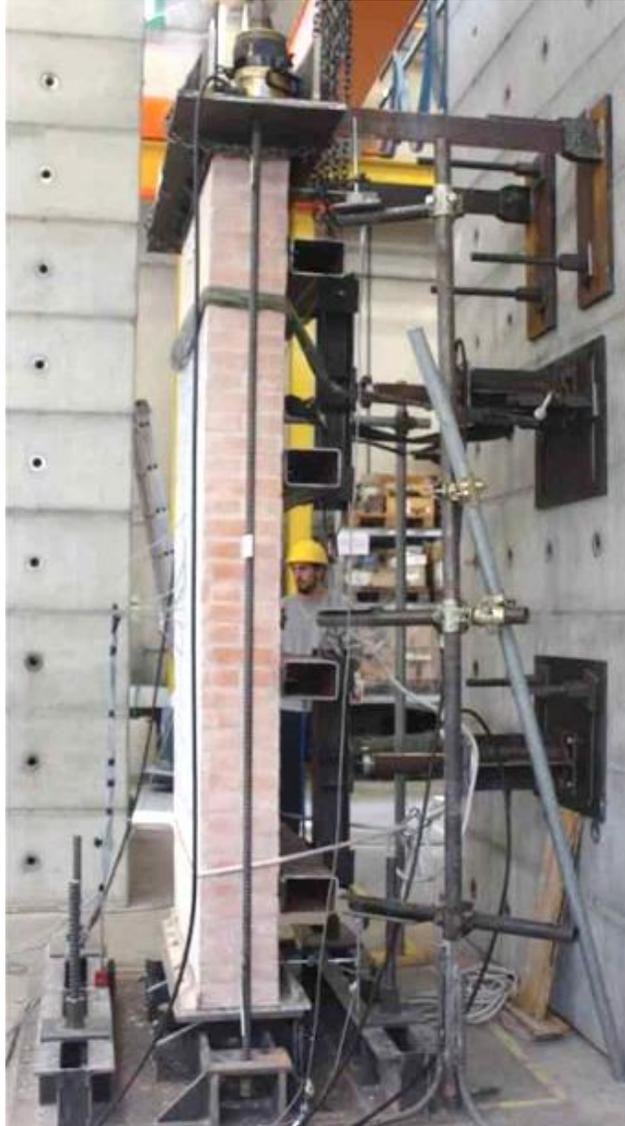
**Fotografía 2-1** Ensayo de flexión perpendicular al plano en muros reforzados con FRCM
