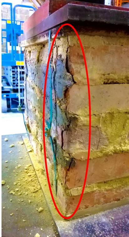
**Fotografía 5-26** Plano de falla en cara reforzada con barras de GFRP, en murete mediano
