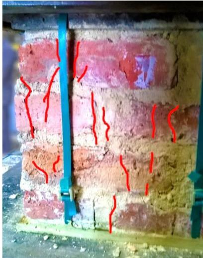
**Fotografía 5-12** Mecanismo de falla de murete de unidad y media, fabricado con mortero de cal adicionado con metacaolín, no reforzado
