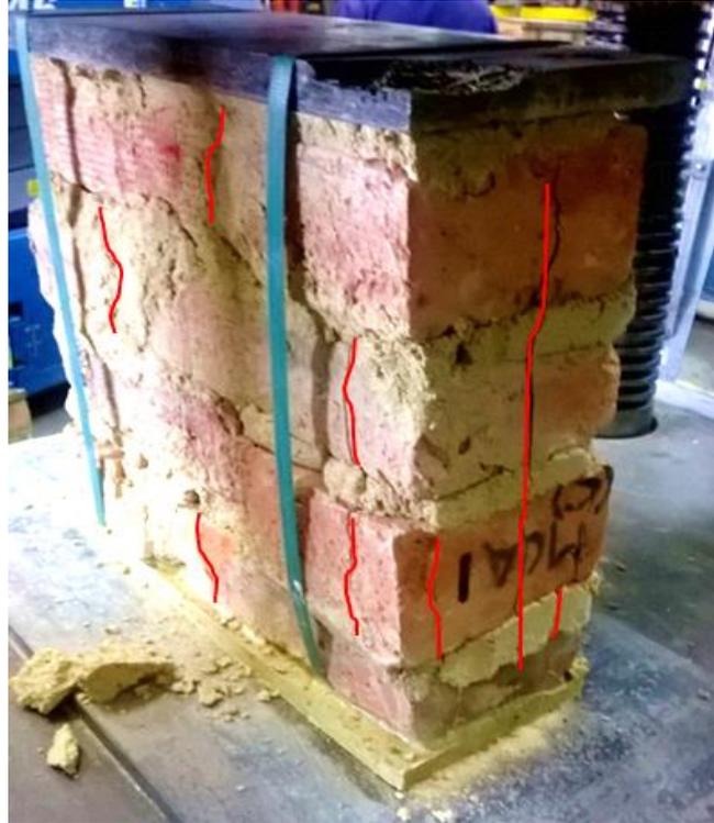
**Fotografía 5-9** Mecanismo de falla de murete de unidad y media, elaborado con mortero de cal y arena
