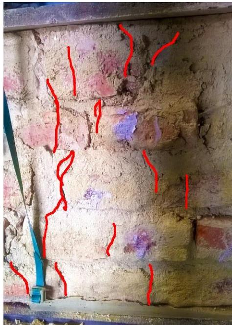
**Fotografía 5-25** Mecanismo de falla en murete mediano, reforzado con barras de GFRP
