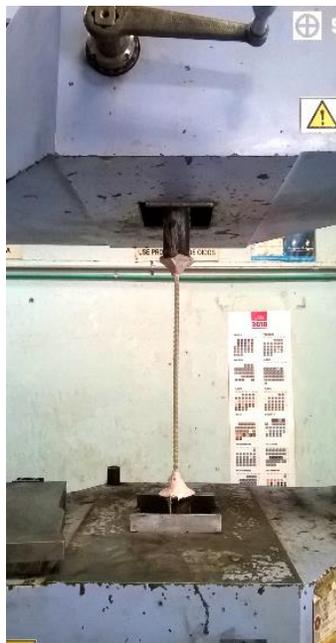
**Fotografía 5-8** Ensayo a tensión en barra de GFRP
