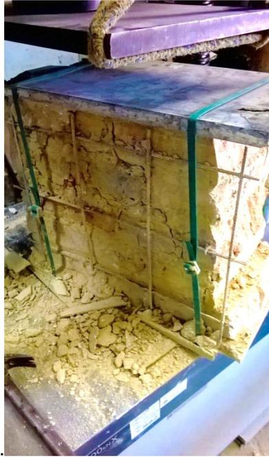
**Fotografía 5-24** Malla de refuerzo después de la falla del murete
