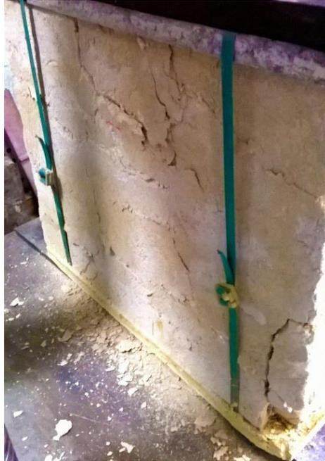
**Fotografía 5-22** Fisuración del mortero de revoque en murete mediano, reforzado con malla electrosoldada
