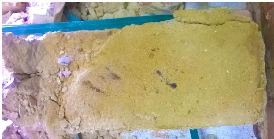
**Fotografía 5-10** Junta de murete de unidad y media, fabricado con mortero de cal, completamente carbonatada
