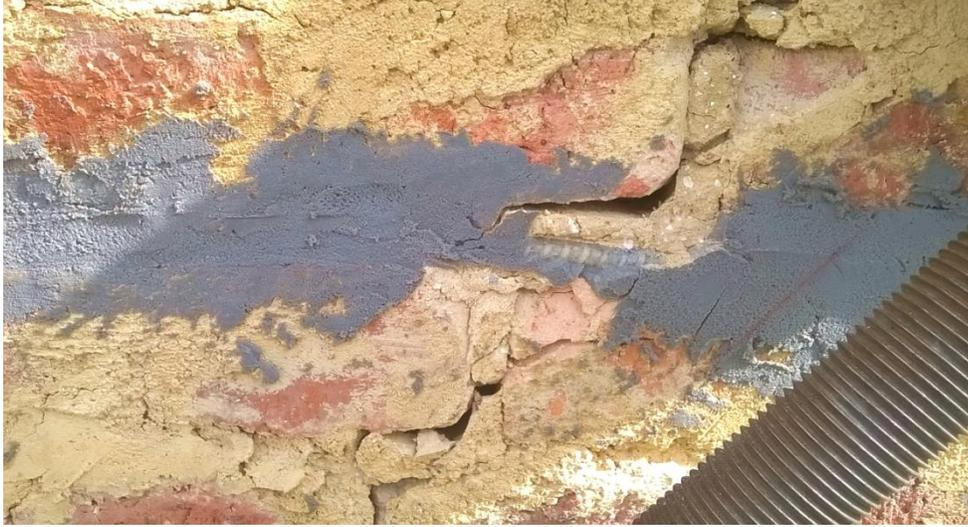
**Fotografía 5-36** Barra de GFRP flectada en una de las juntas, después del ensayo de compresión diagonal
