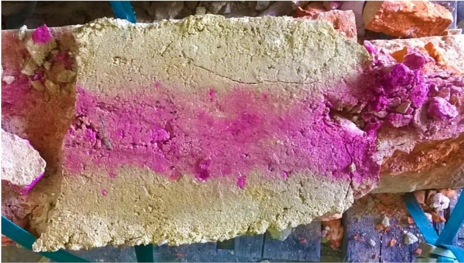
**Fotografía 5-18** Junta de mortero de cal adicionado con metacaolín, en murete de unidad y media
