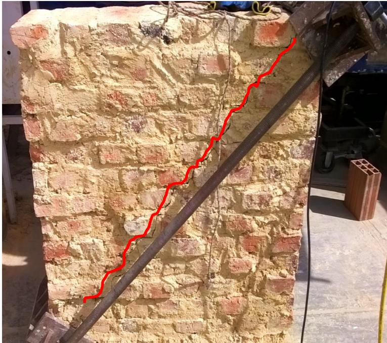
**Fotografía 5-29** Mecanismo de falla en muretes no reforzados, sometidos a compresión diagonal
