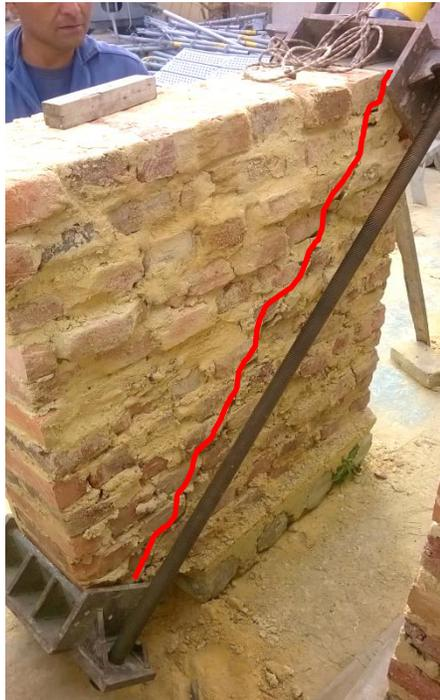
**Fotografía 5-32** Mecanismo de falla en muretes reforzados con malla electrosoldada, sometidos a compresión diagonal
