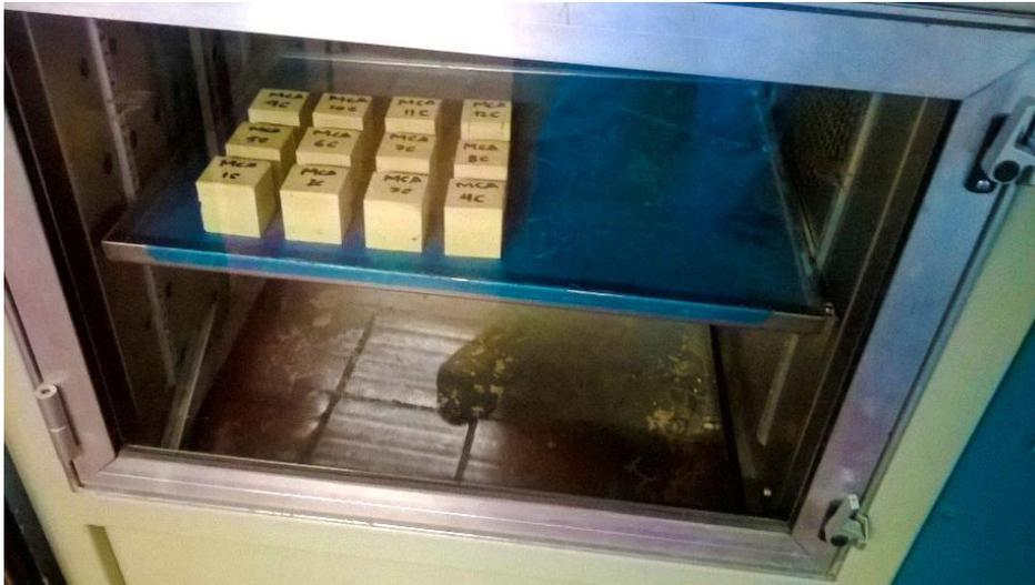
**Fotografía 4-11** Curado de cubos en cámara de carbonatación
