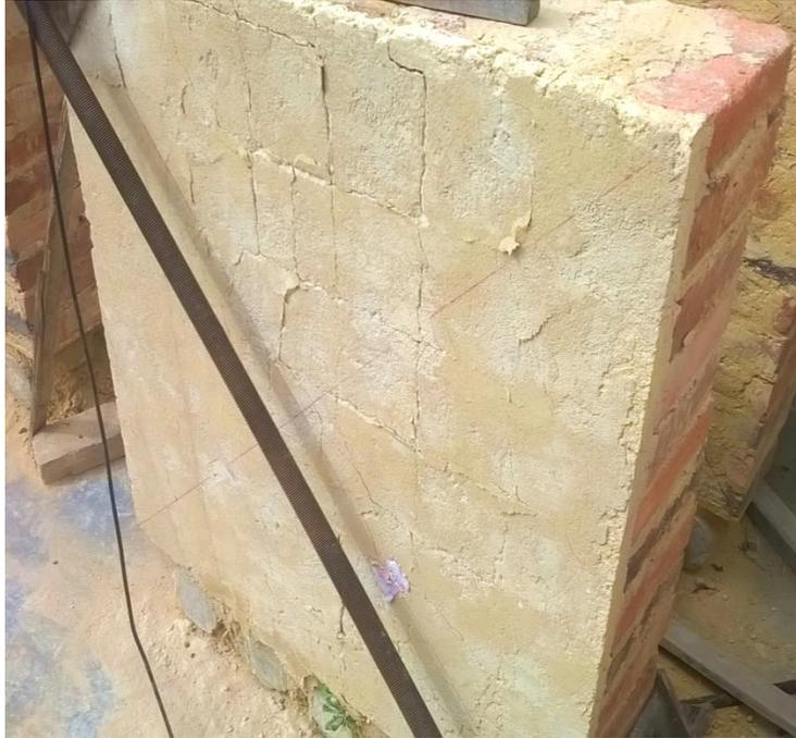
**Fotografía 5-33** Fisuración del mortero de revoque, durante el ensayo de compresión diagonal en murete reforzado con malla electrosoldada
