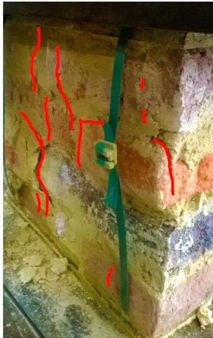
**Fotografía 5-14** Mecanismo de falla en murete de unidad y media, reforzado con malla electrosoldada
