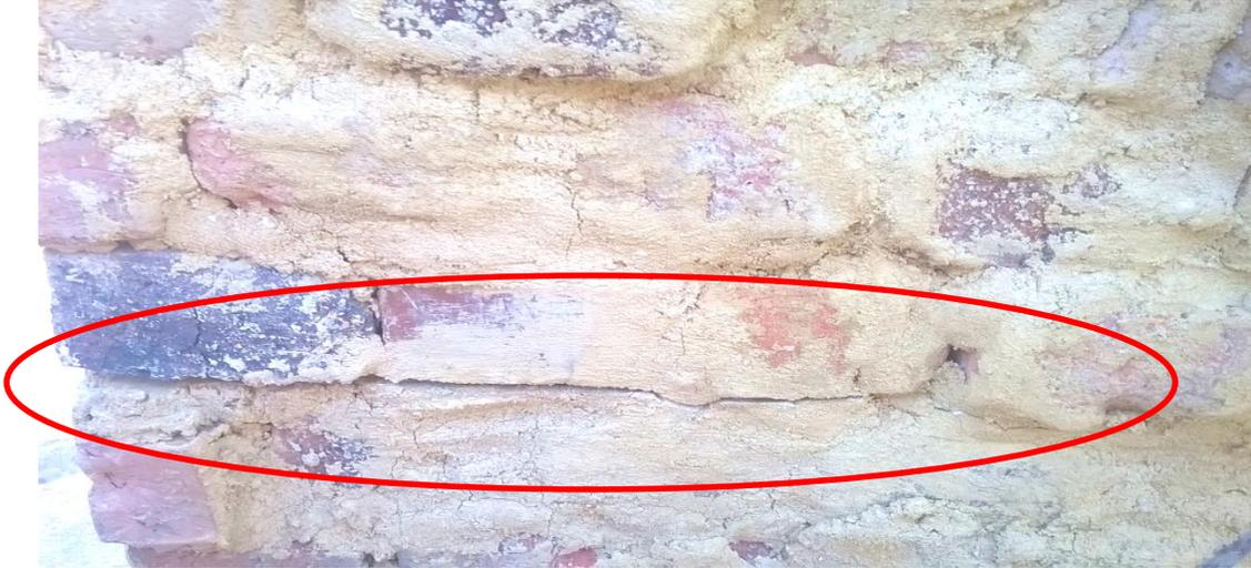
**Fotografía 5-30** Falla por adherencia en junta horizontal en murete no reforzado, durante la prueba de compresión diagonal
