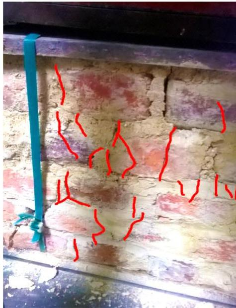
**Fotografía 5-21** Mecanismo de falla en murete de unidad y media, no reforzado
