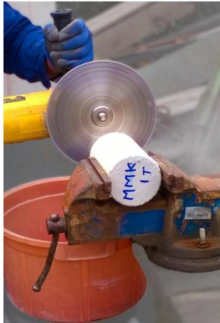
**Fotografía 5-4** Corte de probetas para evaluar la profundidad de carbonatación
