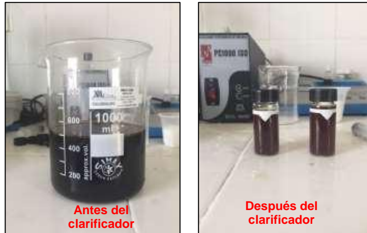
Foto 26. Ensayo de jarras con dosificación actual en la unidad Fuente: Interaseo del Valle S.A.S ESP
