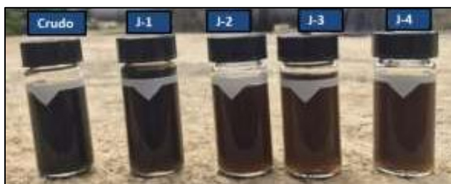
Foto 25. Resultados de ensayo de jarras con T22 y cal viva para la planta fisicoquímica
