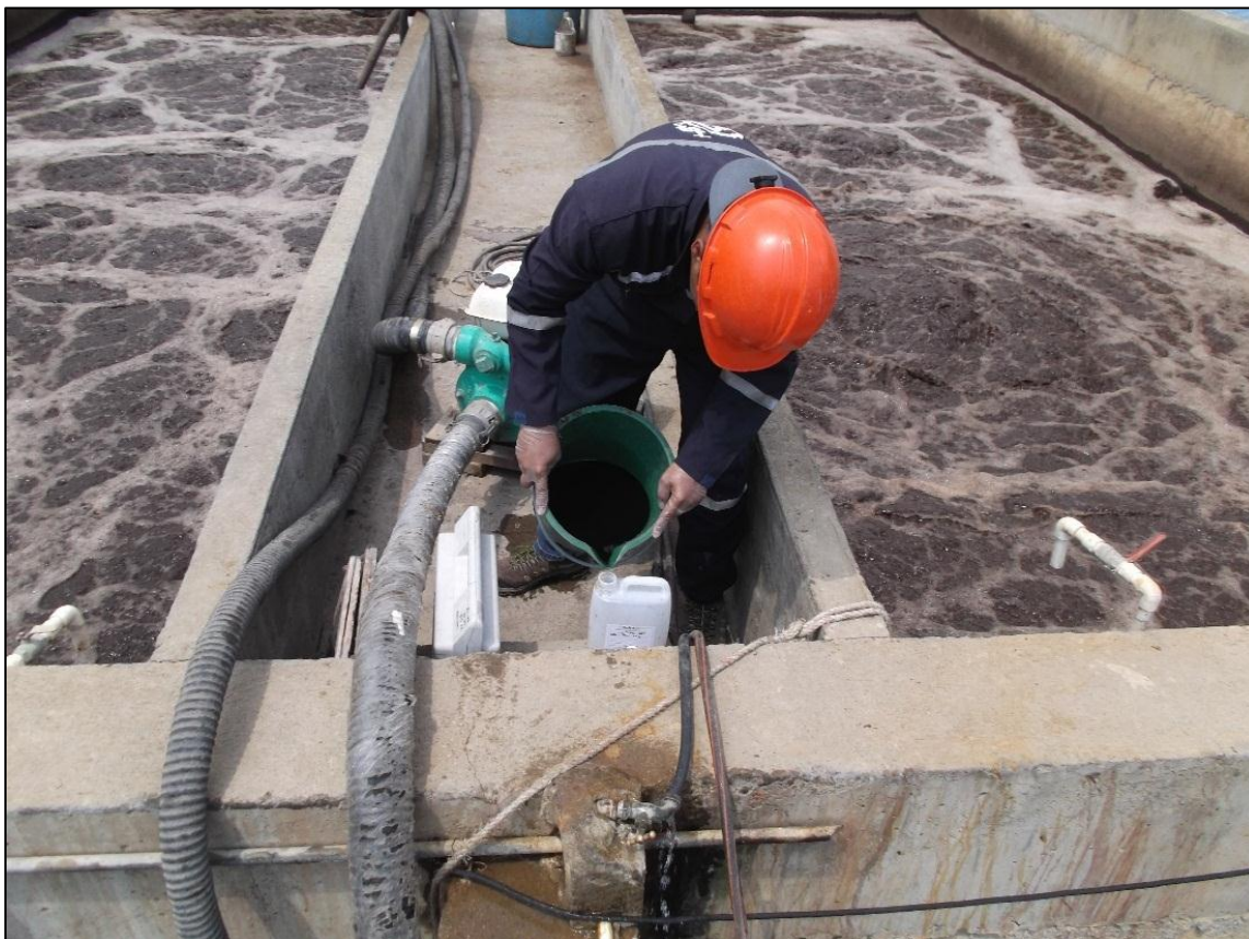
Foto 18. Monitoreo de los tanques aireadores (lodos activados)
