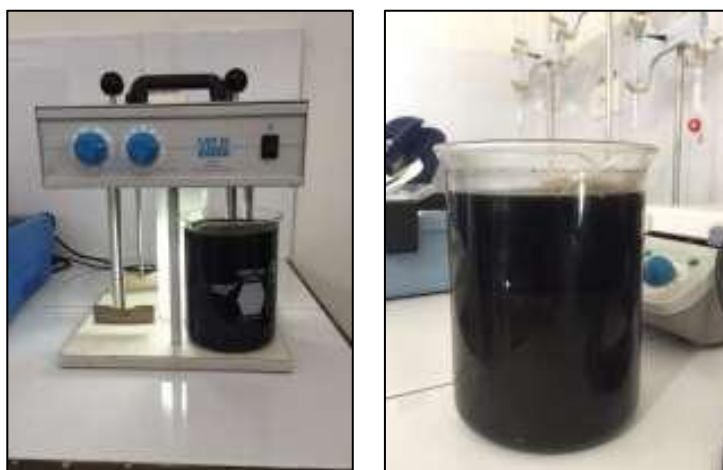
Foto 24. Ensayo de jarras con dosificación actual de la planta
