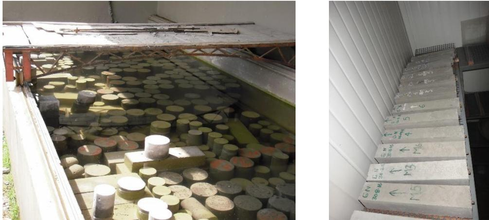
Figura 10. Curado de cilindros de concreto (Derecha Piscina, izquierda cámara de curado). Fuente: Propia.
