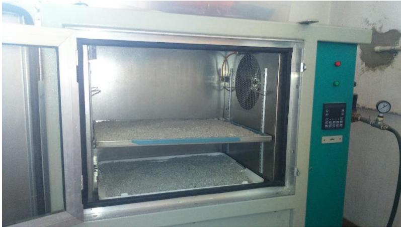
Figura 5. ARC en la cámara de carbonatación acelerada. Fuente: Propia.
