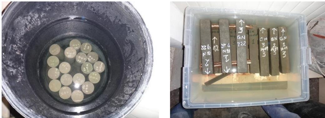
Figura 18. Muestras de concreto sumergidas en una solución de sulfato de magnesio. Fuente: Propia.
