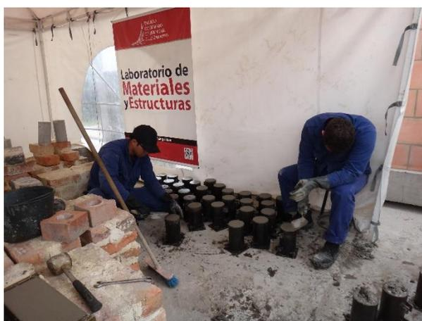
Figura 9. Fundida de cilindros y viguetas de concreto. Fuente: Propia.
