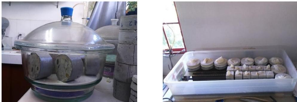
Figura 17. Montaje ensayo sortividad. Fuente: Propia
