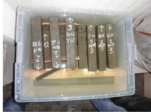
Figura 19. Viguetas en cámara de curado y sumergidas en una solución de sulfato de magnesio.
