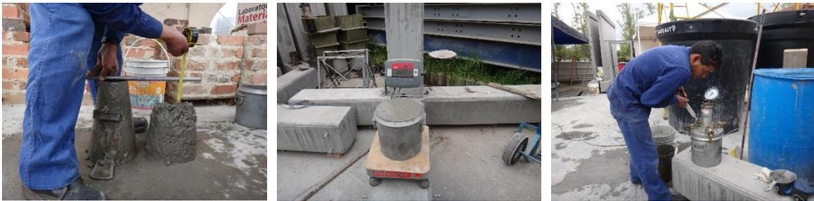
Figura 11. Ensayos de asentamiento, masa unitaria y contenido de aire. Fuente: Propia.
