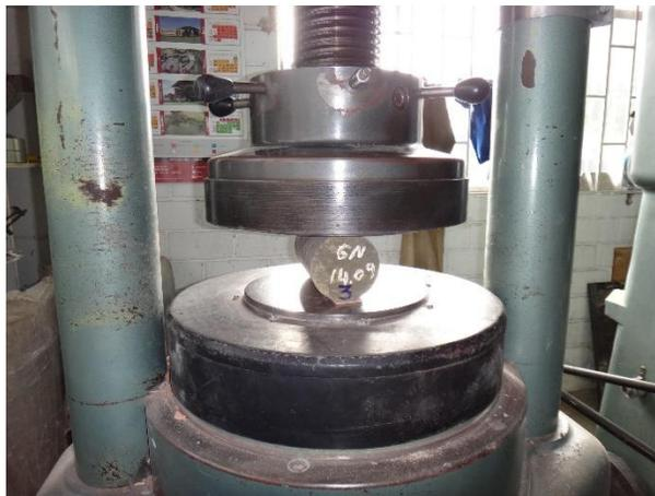
Figura 14. Ensayo de resistencia a la tracción indirecta (ftc). Fuente: Propia.
