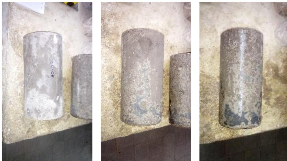
Figura 37. Evolución muestras expuestas a solución de sulfatos. Fuente: Propia.
