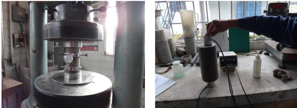
Figura 13. Izquierda-Ensayo módulo de elasticidad. Derecha-Ensayo de velocidad de pulso ultrasónico (VPU). Fuente: Propia.
