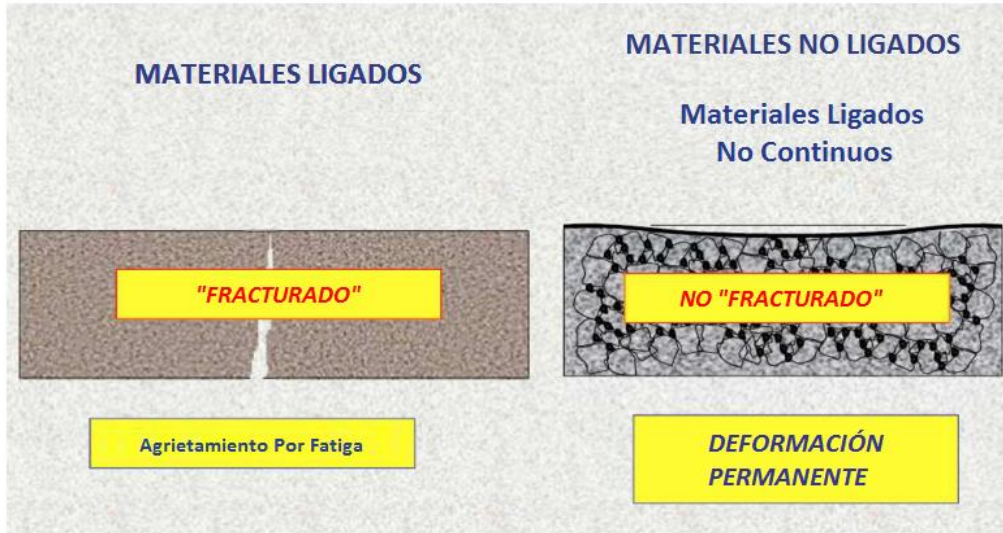
Figura 2.19 Condiciones de Falla en el Pavimento. Adaptado de: (Collings & Jenkins, 2012)
