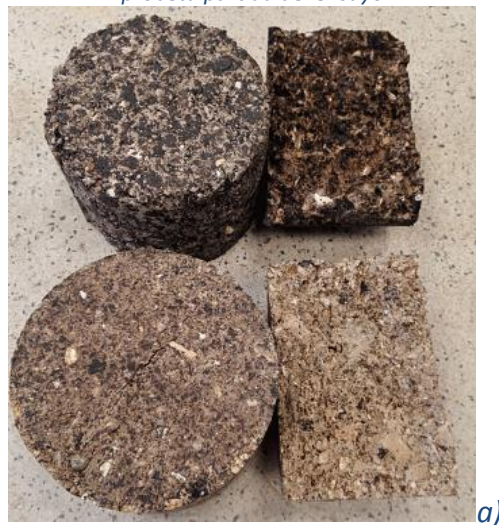
Figura 2.16 Probetas de BSM-FA. a) Probetas Estabilizadas con Asfalto Espumado. b) Material estabilizado con bajo contenido de RAP (15%). c) Material estabilizado con alto contenido de RAP (85%). d) y e) Detalle de las caras de la probeta partida del ensayo.
