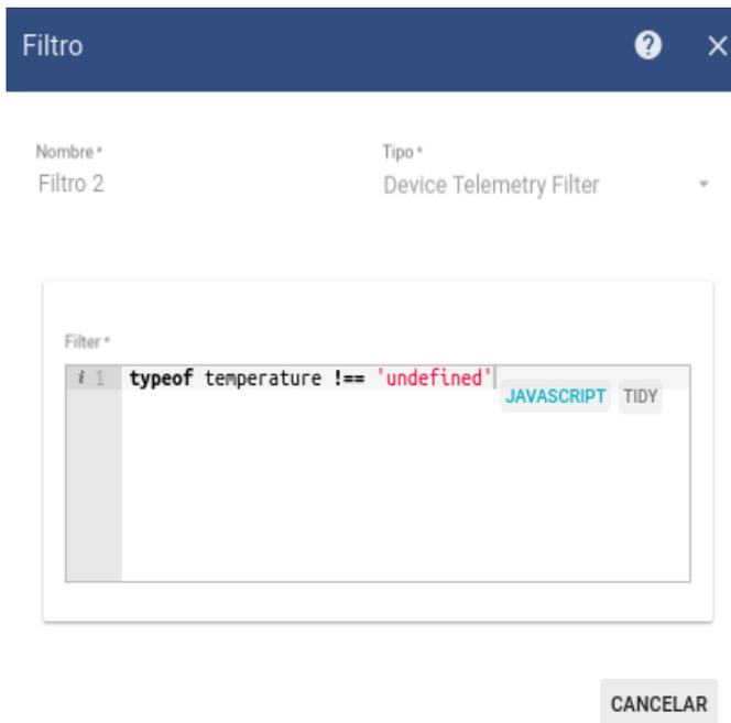
3. Se procede a crear un procesador, y se configura tal y como se muestra en la imagen, en este caso se disparará la alarma cuando la temperatura sea mayor a 35 y se borrará cuando sea menor a 20
