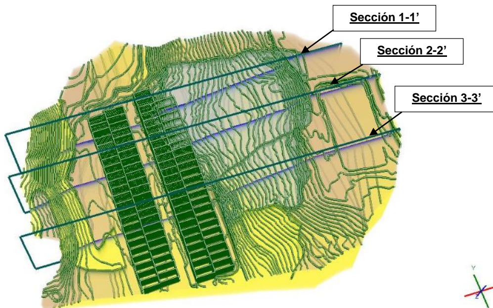
Figura 89. Modelo 3D en el programa RS3, con la localización de las secciones analizadas bidimensionalmente. Fuente: propia.
