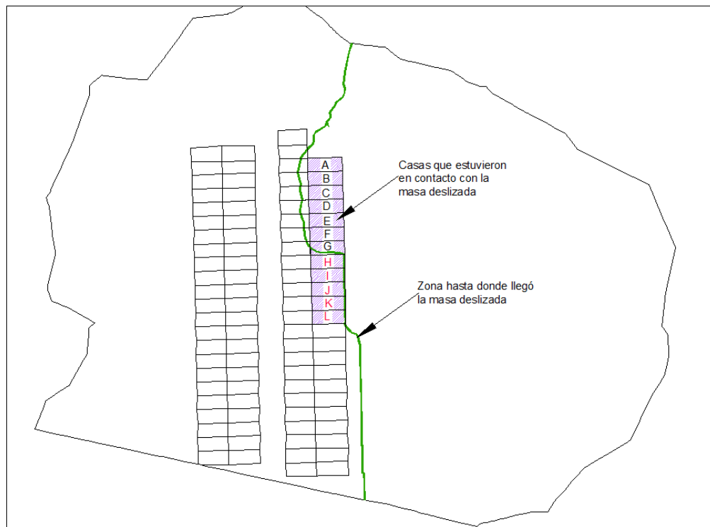
Figura 99. Planta general de la zona de estudio e identificación de las viviendas que estuvieron en contacto con el deslizamiento. Fuente: propia.
