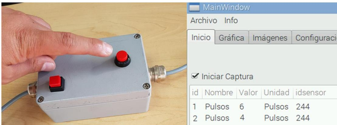
Figura 63. Verificación de pulsos leídos por el prototipo.
