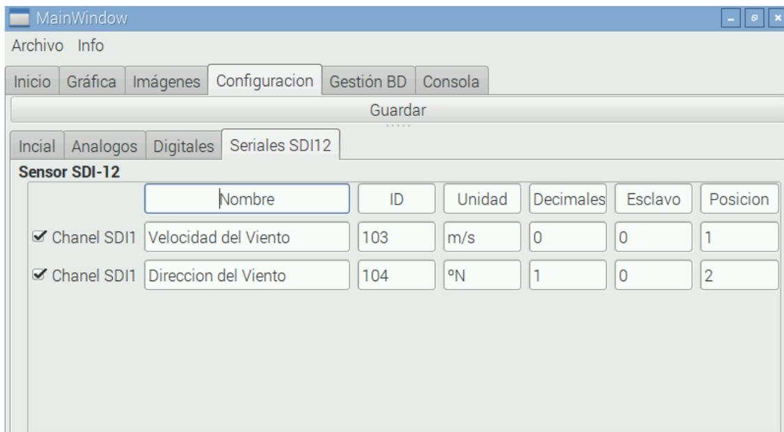
Figura 46. Panel de configuración - Entrada serial SDI-12
