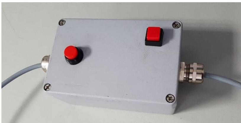
Figura 62. Generador de pulsos digitales
