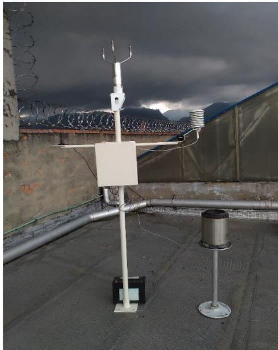
Figura 91. Estructura física estación meteorológica
