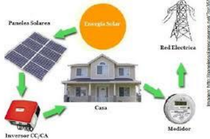
Ilustración 18 Generación de Energía Paneles Fotovoltaicos
