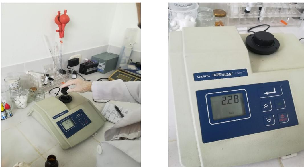
Fotografía 47 Análisis de laboratorio, determinación de turbidez
