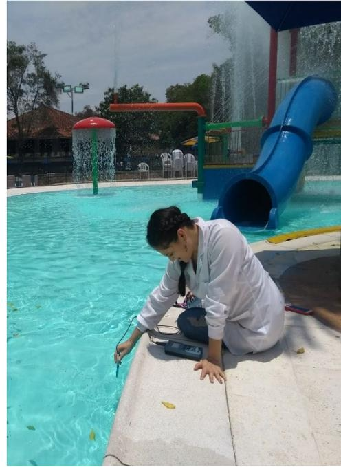
Fotografía 45 Muestreo Kit portátil test de Cloro y pH
