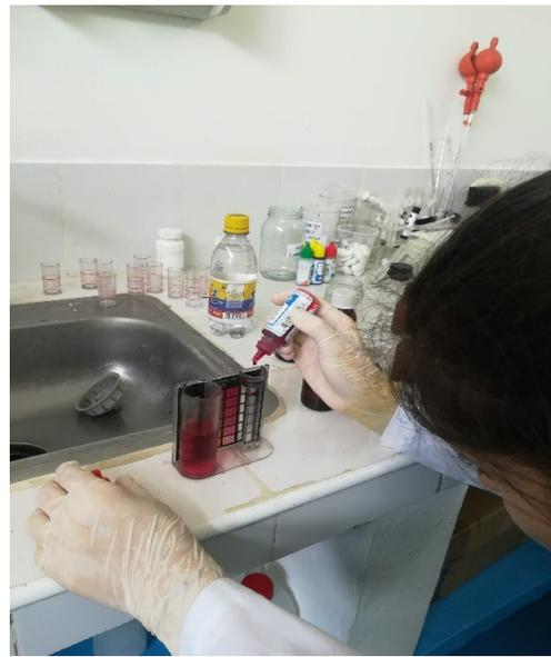
Fotografía 46 Determinación de pH, Cloro Libre y cloraminas
