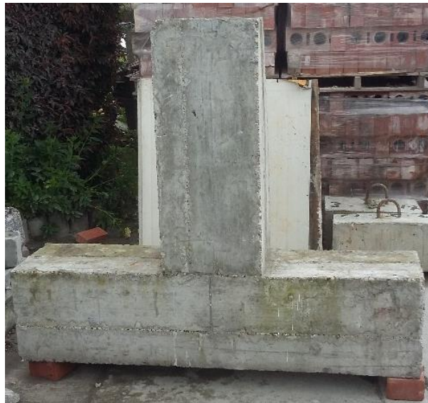
Fotografía 4-6: espécimen monolítico ya fundido.
