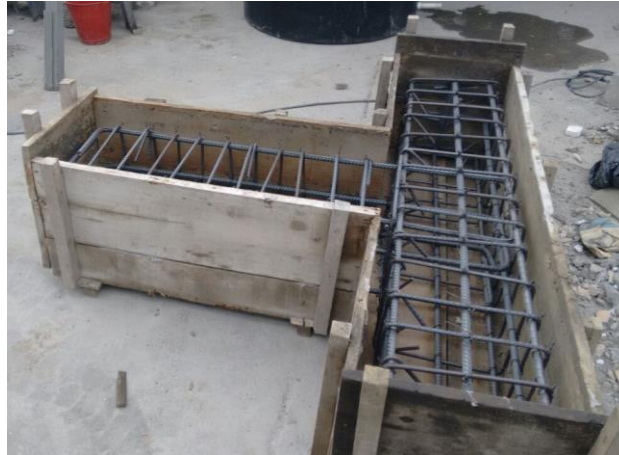
Fotografía 4-5: Refuerzo especímenes monolíticos en formaleta de madera.
