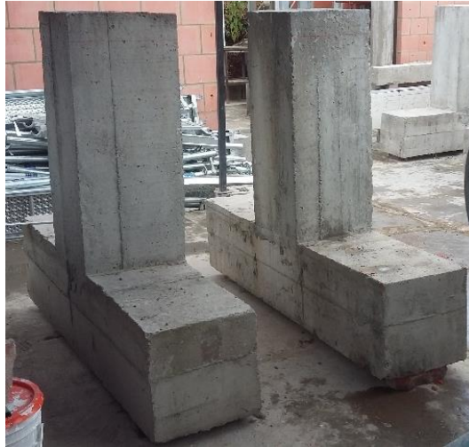
Fotografía 4-7: Especímenes unión viga-columna reforzada después de la fundida.
