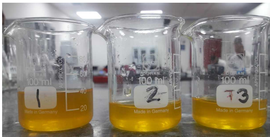
Figura 16. Muestra 4 – Dosis 3: 31,8 g/L de H_2O_2 y 2,38 g/L – Fe^{++} (27/11/2018)
