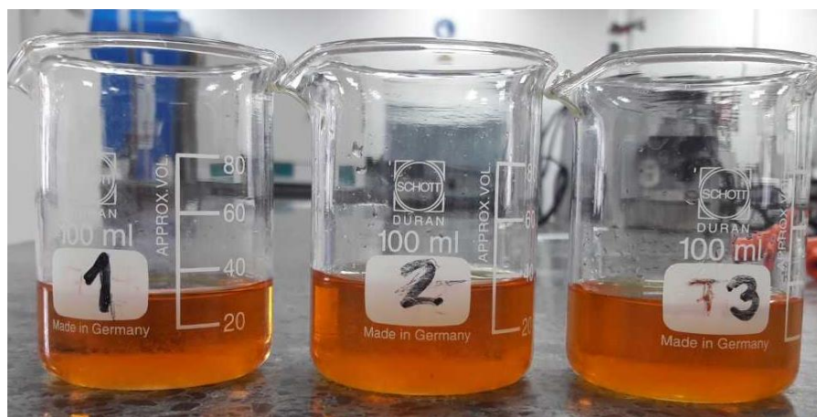
Figura 17. Muestra 4 – Dosis 4: 47,7 g/L de H_2O_2 y 3,57 g/L – Fe^{++} (28/11/2018)
