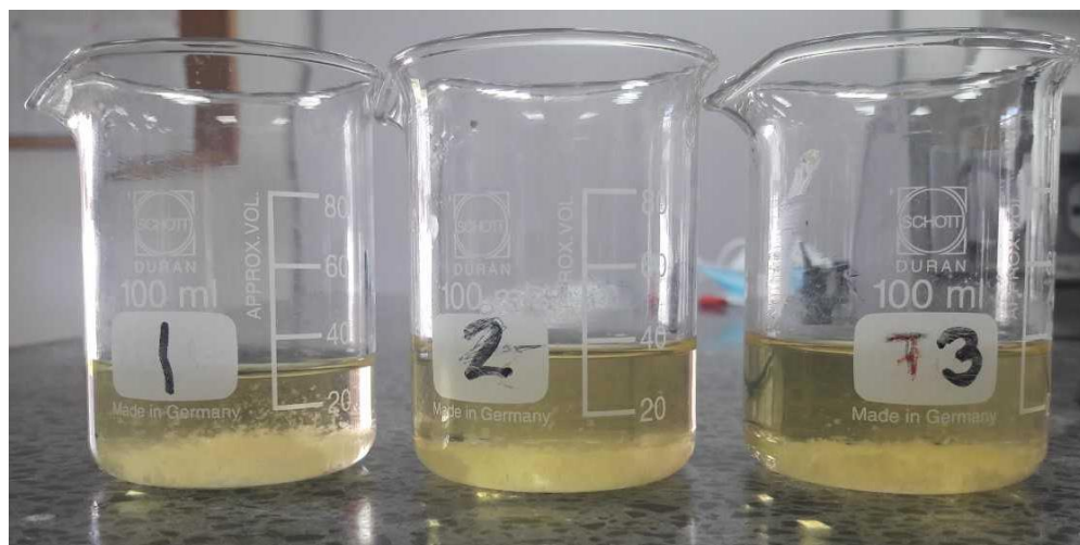
Figura 15. Muestra 4 – Dosis 2: 15,9 g/L de H_2O_2 y 1,19 g/L – Fe^{++} (26/11/2018)
