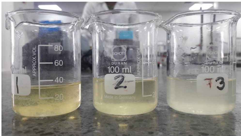
Figura 14. Muestra 4 – Dosis 1: 7,95 g/L de H_2O_2 y 0,60 g/L – Fe^{++} (23/11/2018)
