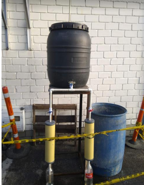
Fotografía 4. Montaje de los Filtros
