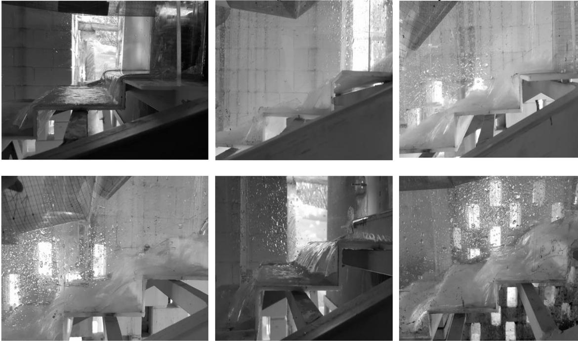
Ilustración 16. Perfil de flujo estructura 1:5.  $Q = 2.70$  lps
