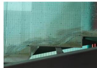
Anexo 29. Fotografías perfil de flujo en la estructura 1:5  $Q = 5.54$  lps (EE)
