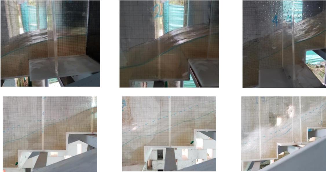
Anexo 21 Fotografías perfil de flujo en la estructura 1:3  $Q = 14.39$  lps (R)
