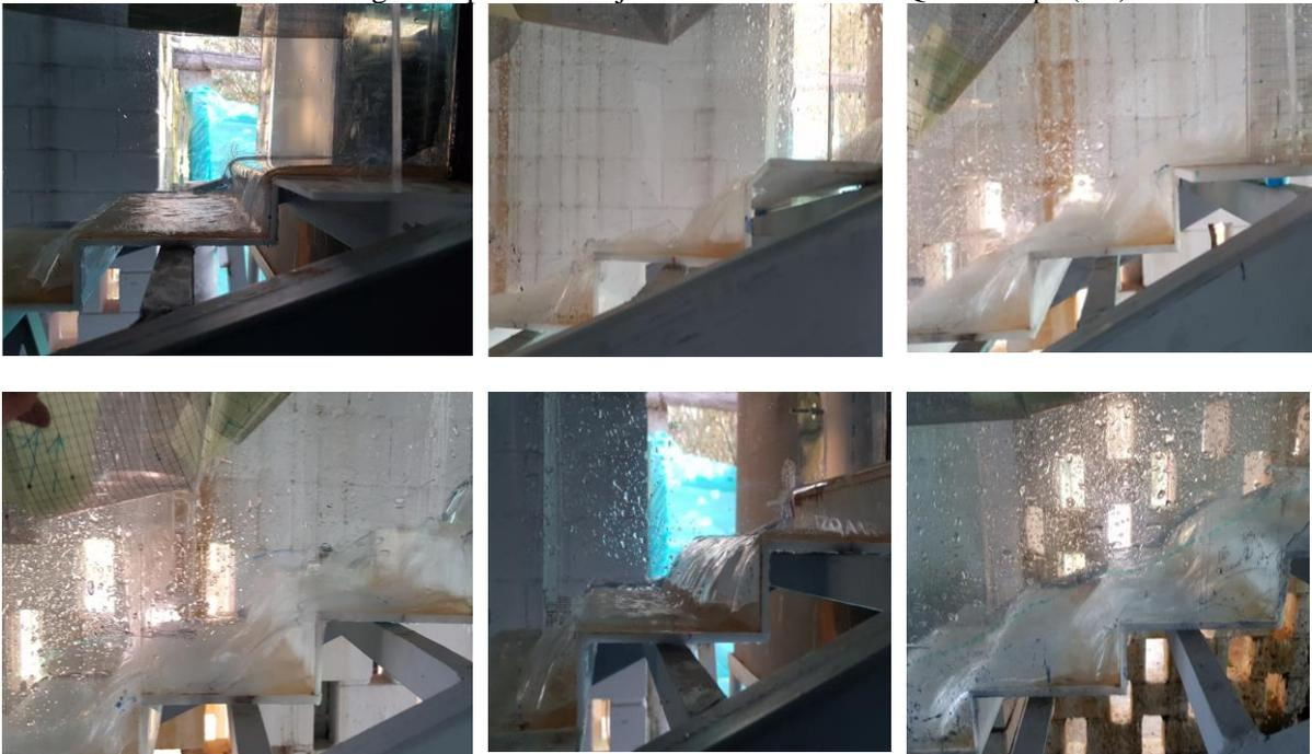
Anexo 17. Fotografías perfil de flujo en la estructura 1:3  $Q = 3.62$  lps (EE)
