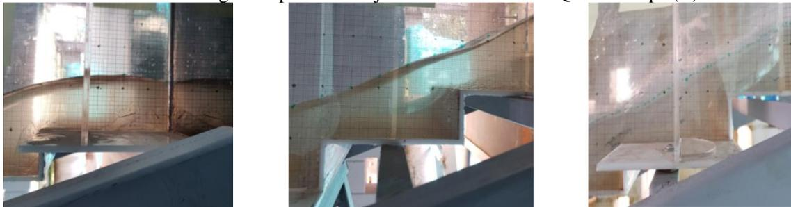
Anexo 22 Fotografías perfil de flujo en la estructura 1:3 Q = 18.48 lps (R)
