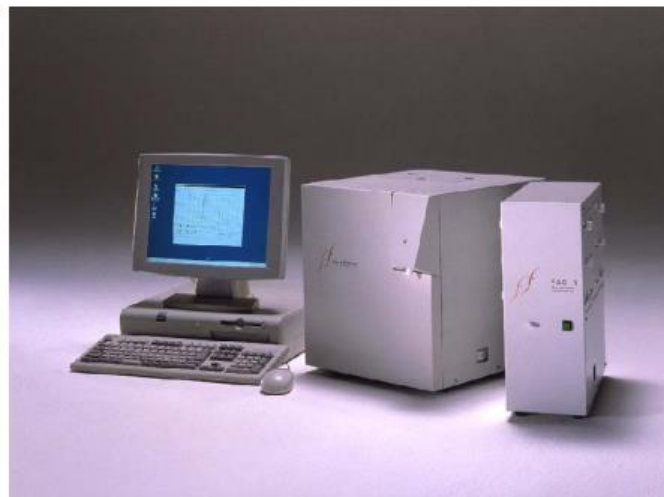
Ilustración 9. Apariencia real de una nariz electrónica.
